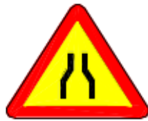
ESTRECHAMIENTO DE CALZADA (TP-17)
