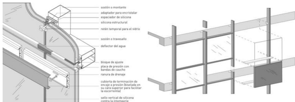
Figura PR-3 Esquemes del muntatge d'un mur cortina
