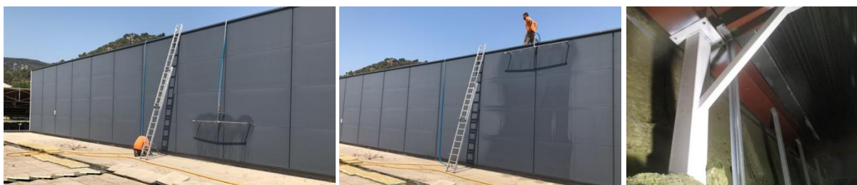
Figura RT-13 Fotografies Prova d'estanquitat P2
