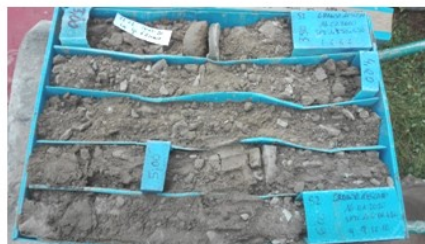
Caixa nº 2: Testimonis extrets del sondeig S-1 compresos entre 3,00 - 6,00 m de fondària.
