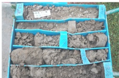
Caixa nº 1: Testimonis extrets del sondeig S-1 compresos entre 0,00 - 3,00 m de fondària.
