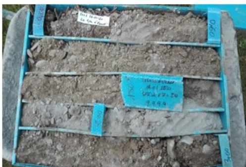
aixa nº 1: Testimonis extrems del sondeig S-1 compresos entre 0,00-3,00 m de fondària.
