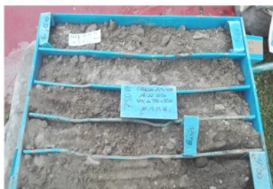
Caixa nº 1: Testimonis extrets del sondeig S-1 compresos entre 0,00 - 3,00 m de fondària.
