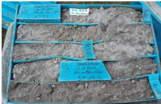
Caixa nº2: Testimonis extrems del sondeig S-1 compresos entre 3,00-6,00 m de fondària.
