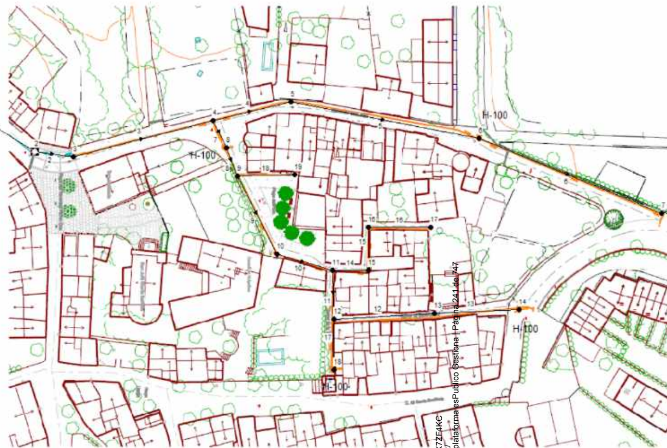
Figura 1: Esquema de la xarxa de subministrament d'aigua amb el punt base
