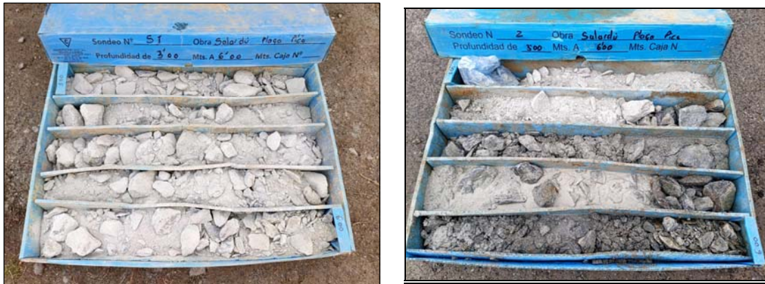
Fotografia 5 i 6. Detall dels materials del nivell 1, tal i com es recuperen en dos dels sondeigs realitzats.
