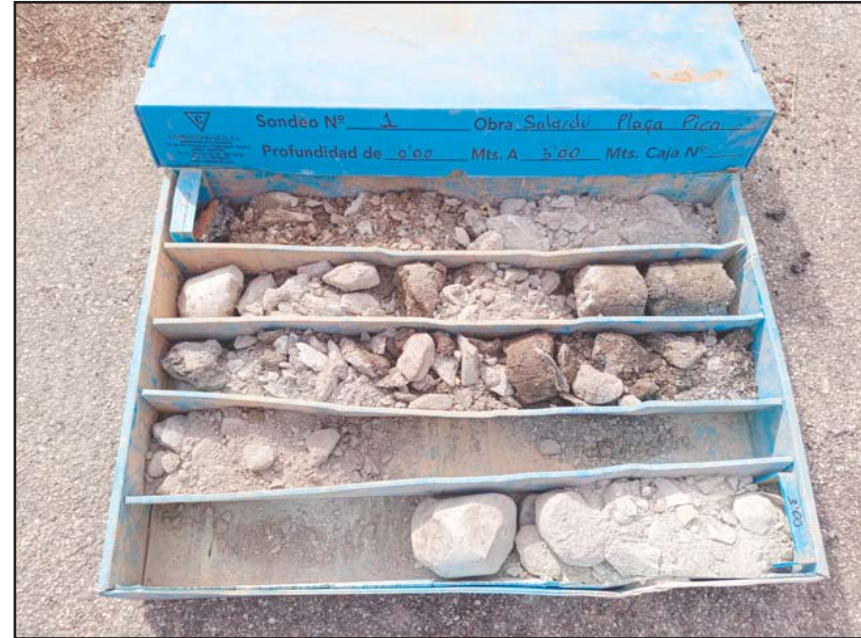
Fotografia 2. Detall dels materials recuperats en el sondeig S-1, de 0 a 3.0 metres.
