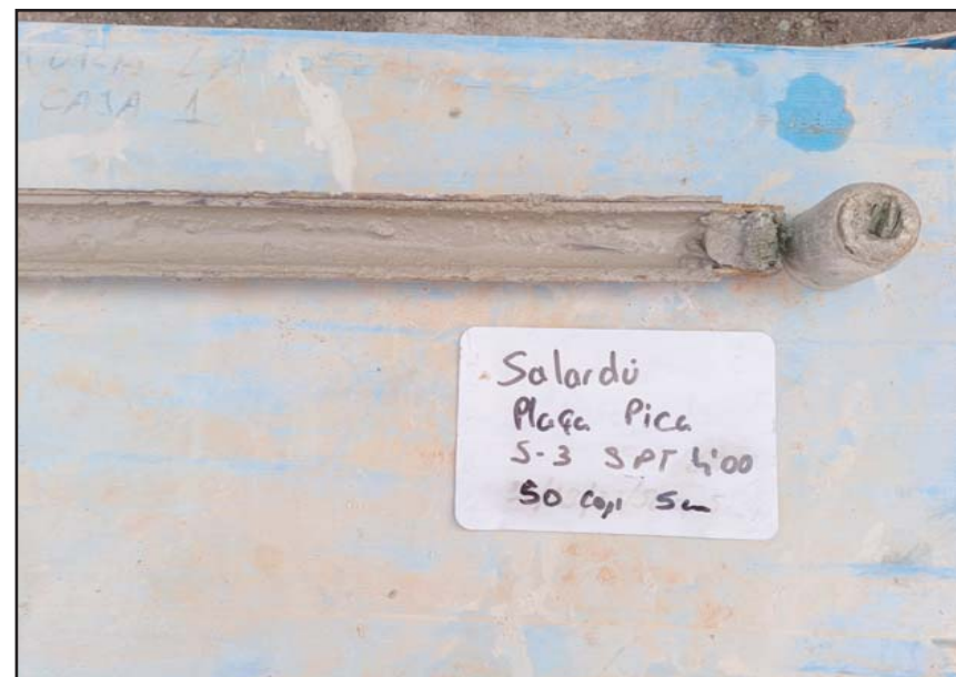
Fotografia 6. Detall dels materials recuperats de l'assaig SPT-2.
