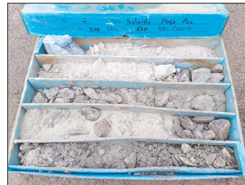
Fotografia 3. Detall dels materials recuperats en el sondeig S-2, de 3.0 a 6.0 metres.
