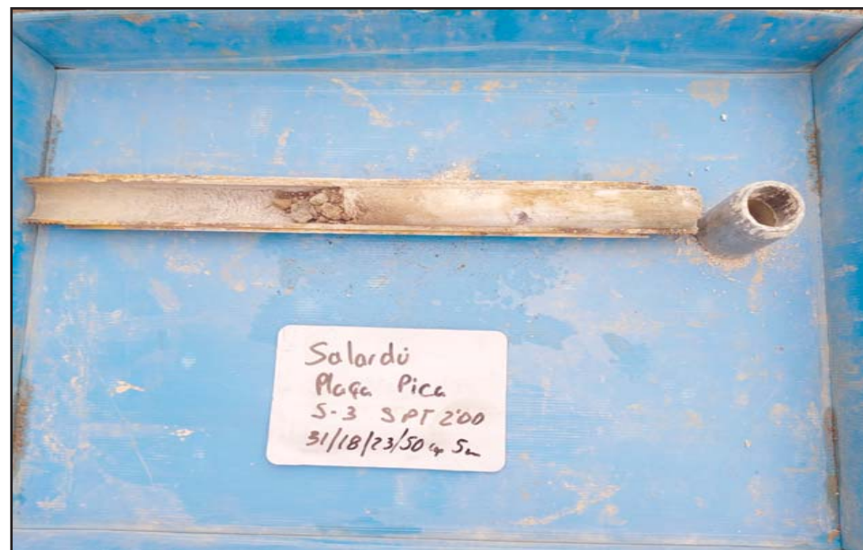
Fotografia 5. Detall dels materials recuperats de l'assaig SPT-1.
