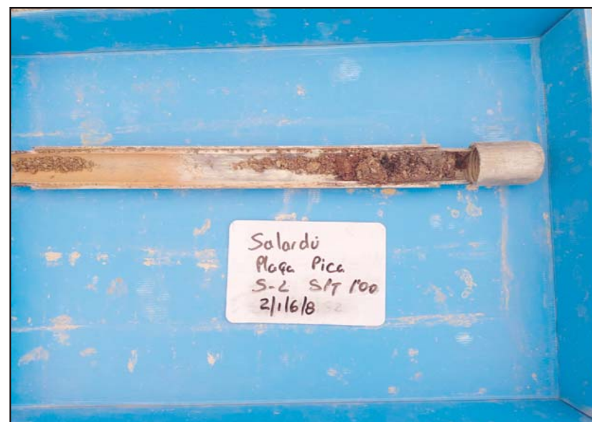
Fotografia 5. Detall dels materials recuperats de l'assaig SPT-1.
