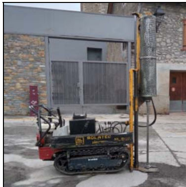
Fotografia 2. Detall de la màquina realitzant l'assaig DPSH.
