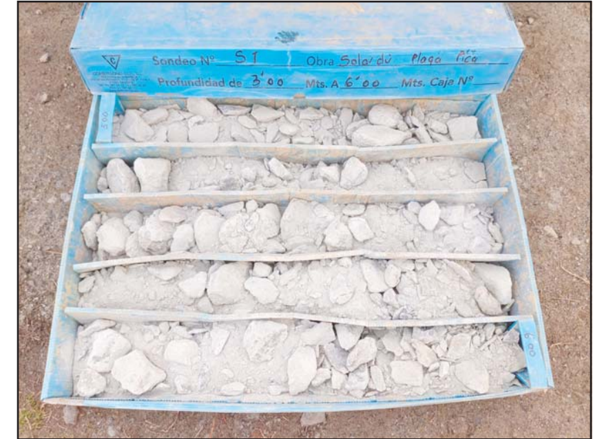
Fotografia 3. Detall dels materials recuperats en el sondeig S-1, de 3.0 a 6.0 metres.
