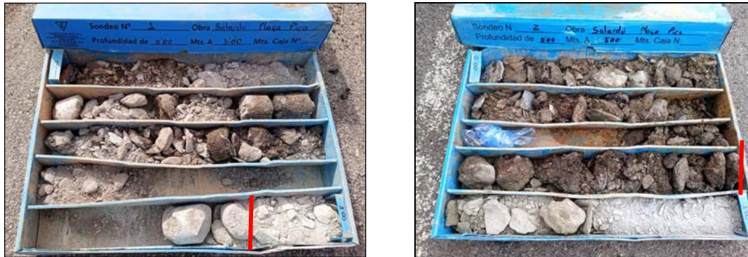
Fotografia 3 i 4. Detall dels materials del nivell R tal i com es recuperen en dos dels sondeigs realitzats.
