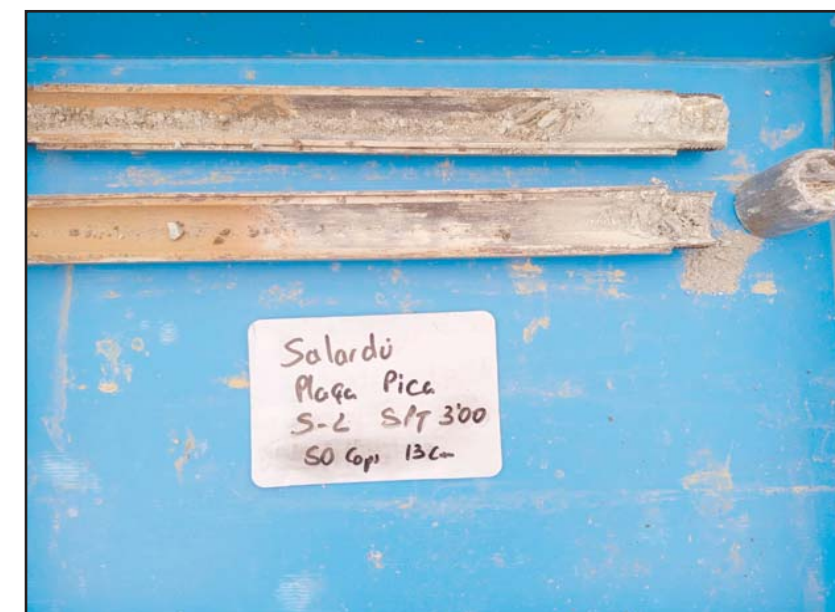
Fotografia 6. Detall dels materials recuperats de l'assaig SPT-2.
