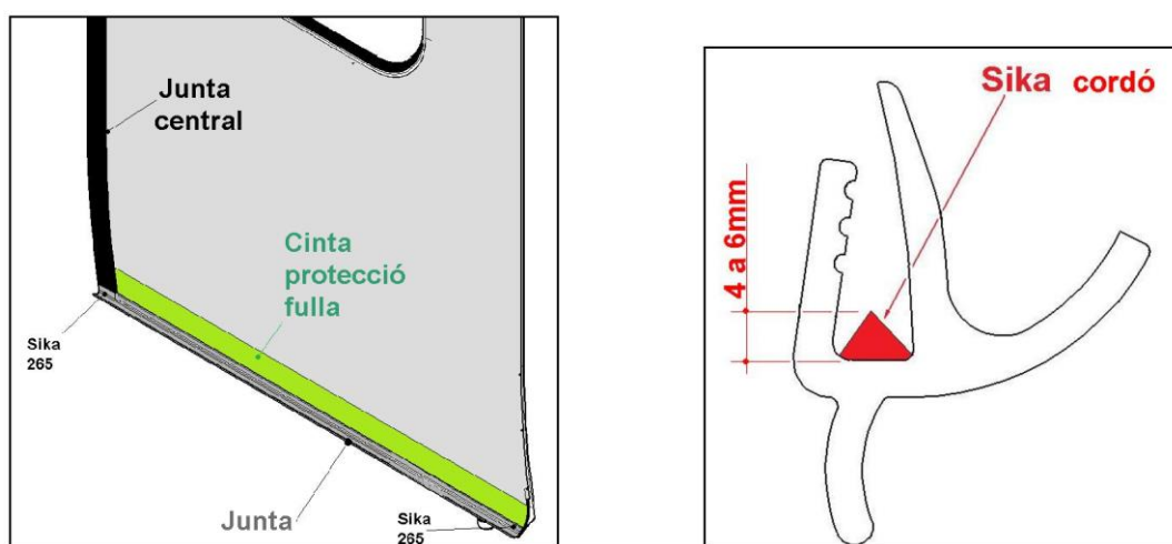
Figura C.24. Substitució de les juntes escopidors
