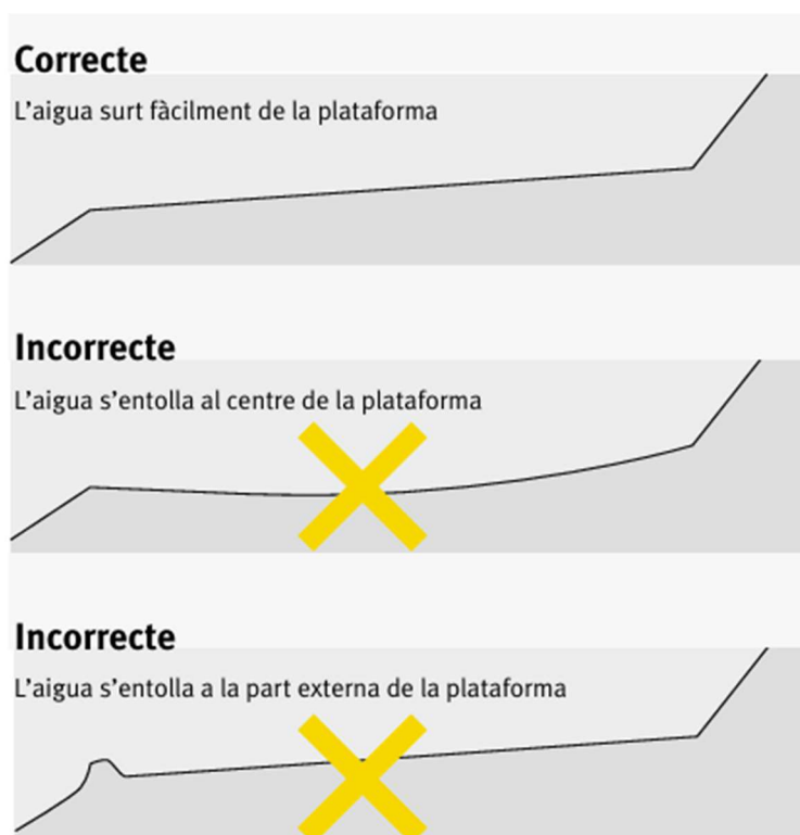
Imatge 20. El pendent transversal de la plataforma facilita l'evacuació de l'aigua i
