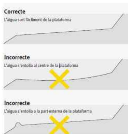
Figura 5: Pendent transversal de la pista forestal
