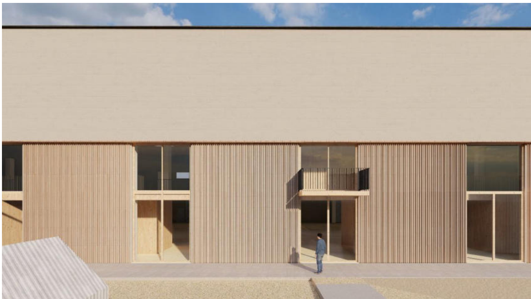
Vista real a nivell de paviment de la façana del cos B. Panell prefabricat de formigó prefabricat texturitzat imitant un encofrat de fusta amb rastrellat vertical de fusta carbonitzada a la franja d'obertures.
