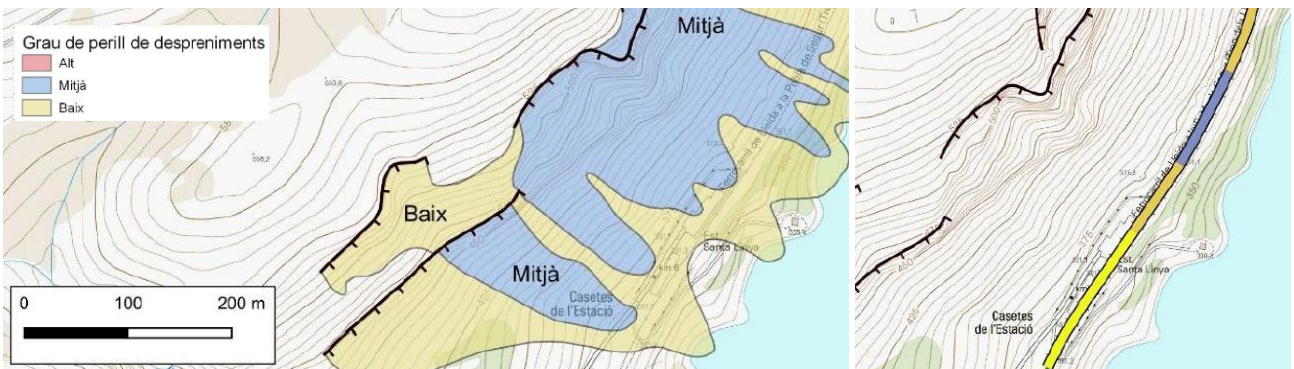
Figura 3. Sector de l'estació de Santa Linya: Zonificació del perill davant desprendiments de roques en el vessant LP32VE03.
