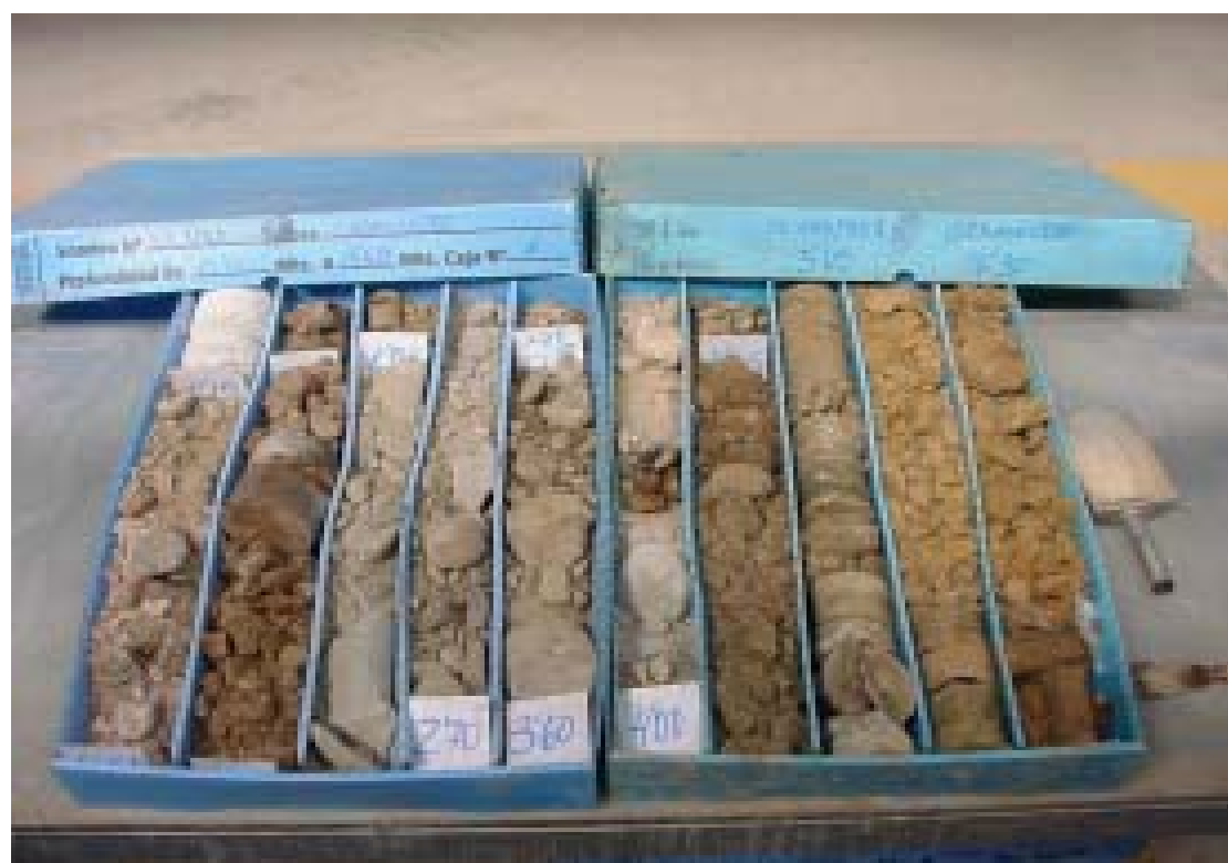
Caixes de testimonis corresponents al sondatge S-4 (0,00 – 7,30 m)
