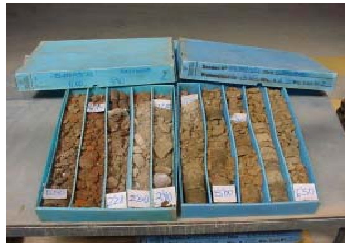
Caixes de testimonis corresponents al sondatge S-2 (0,00 – 6,50 m)
