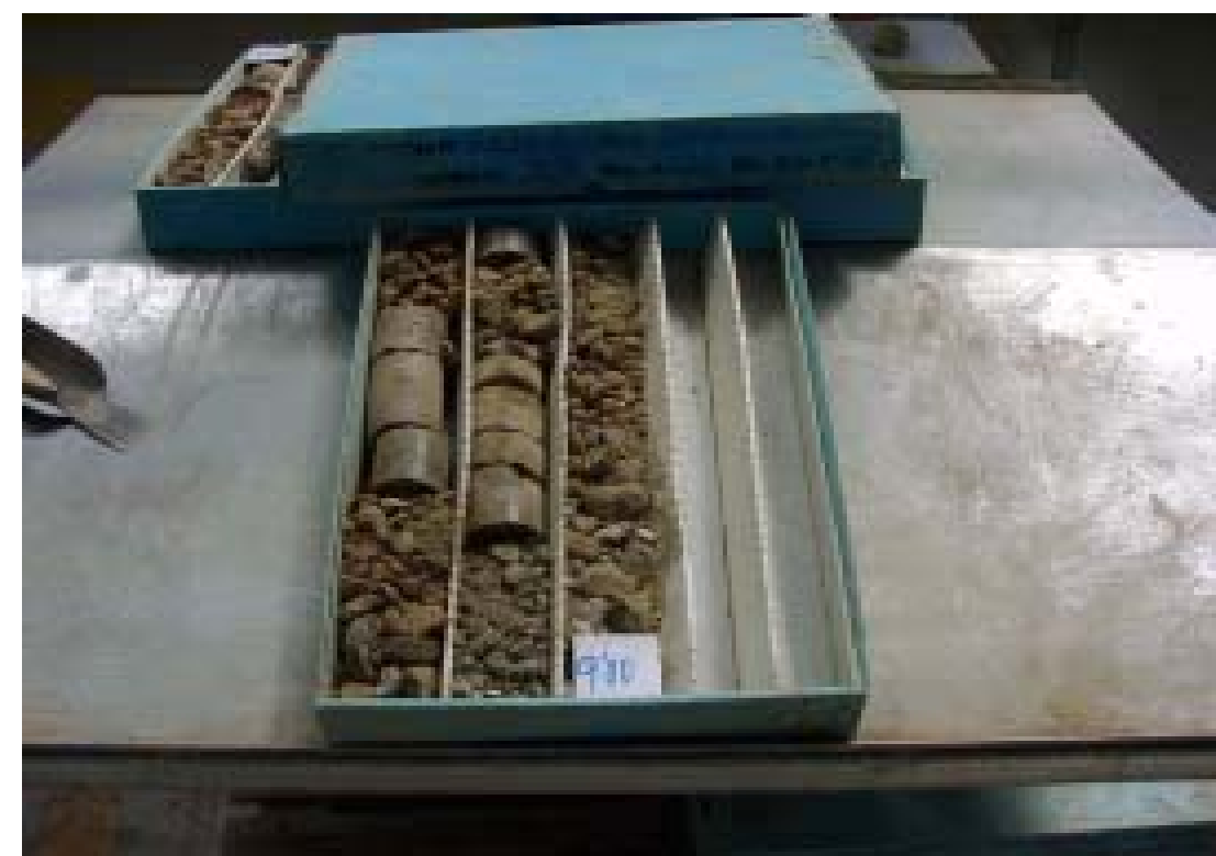
Caixes de testimonis corresponents al sondatge S-5 (7,50 – 9,00 m)
