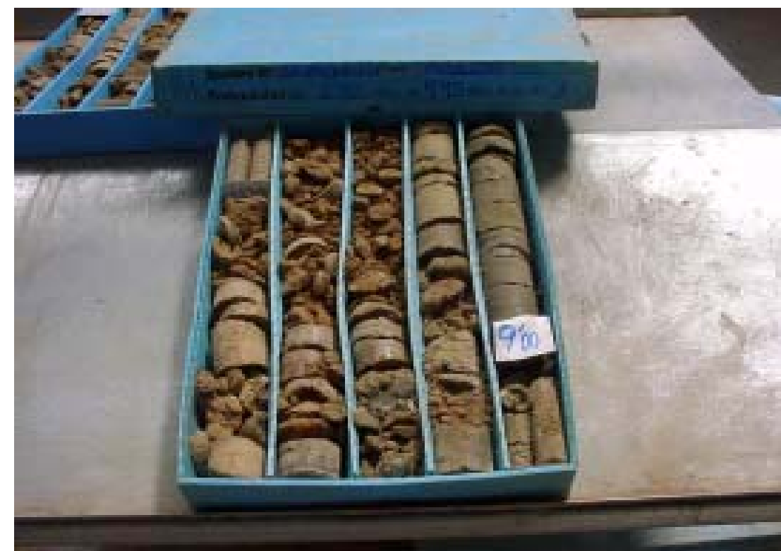
Caixes de testimonis corresponents al sondatge S-2 (6,50 – 9,45 m)
