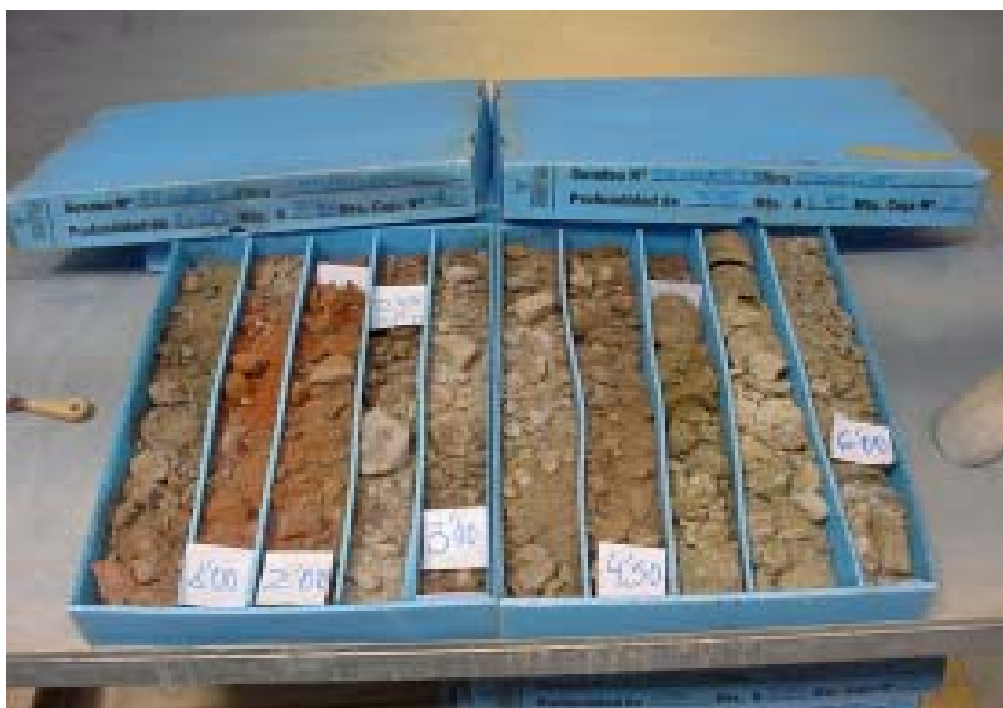
Caixes de testimonis corresponents al sondatge S-1 (0,00 – 6,45 m)
