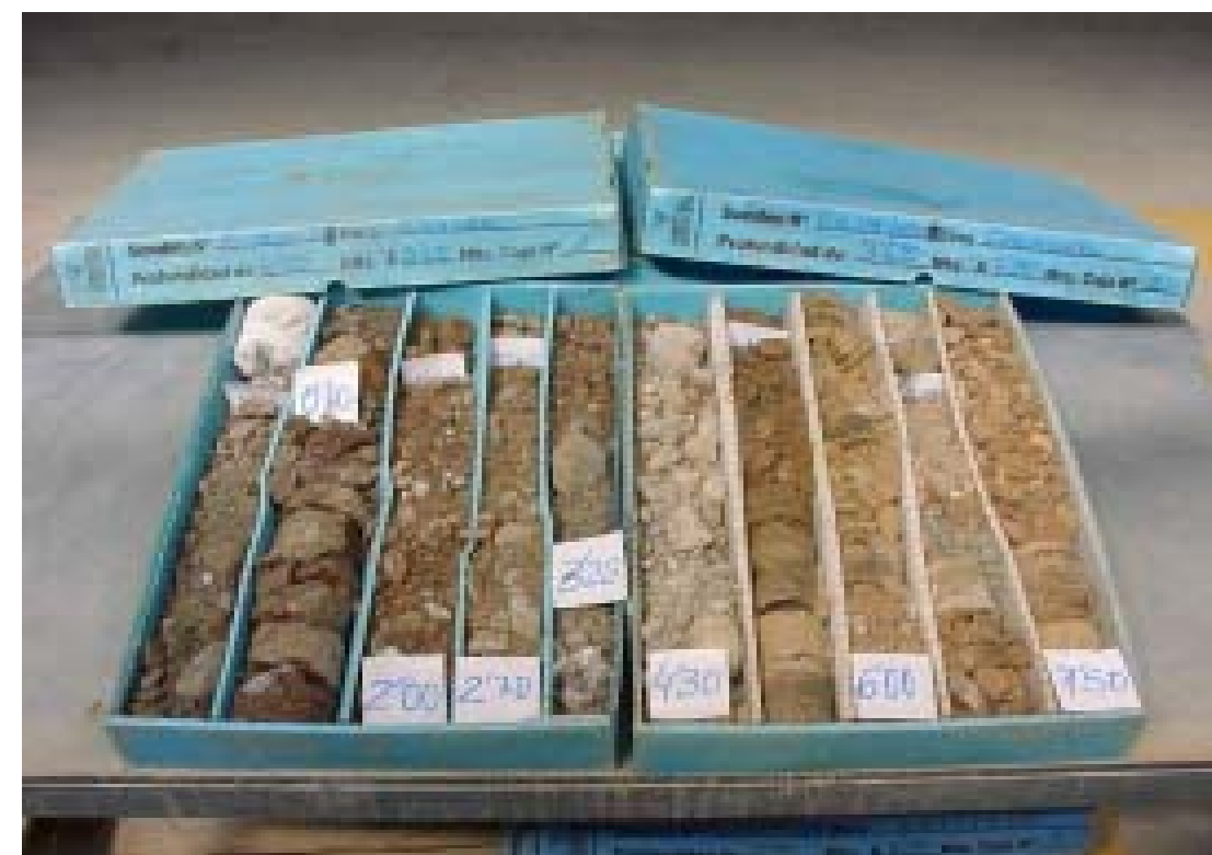
Caixes de testimonis corresponents al sondatge S-5 (0,00 – 7,50 m)
