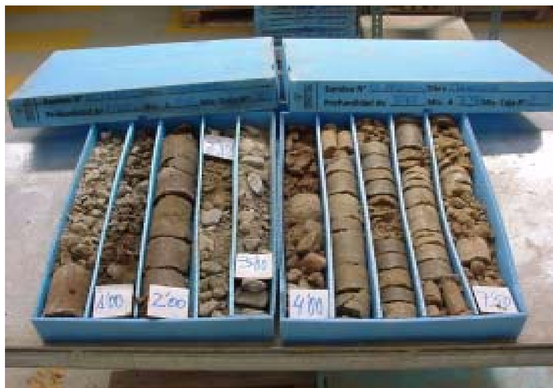
Caixes de testimonis corresponents al sondatge S-3 (0,00 – 7,50 m)
