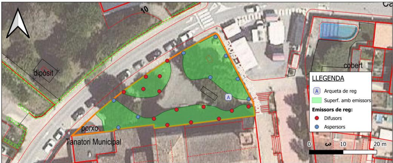
Imatge 54. Inventari del sistema de reg del Parc del Tanatori.
