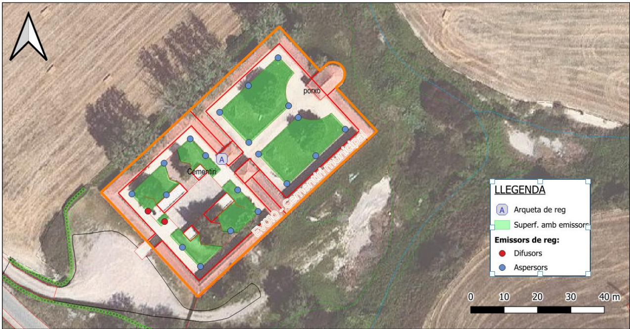
Imatge 36. Inventari del sistema de reg del Cementiri municipal de Tona.
