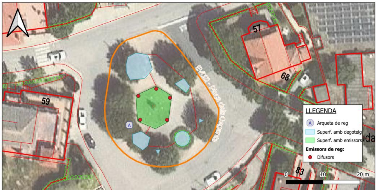
Imatge 58. Inventari del sistema de reg del Plaça dels Gegants.
