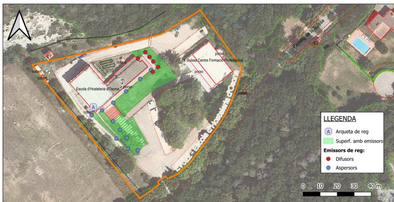
Imatge 60. Inventari del sistema de reg de l'Escola d'Hosteleria d'Osona.
