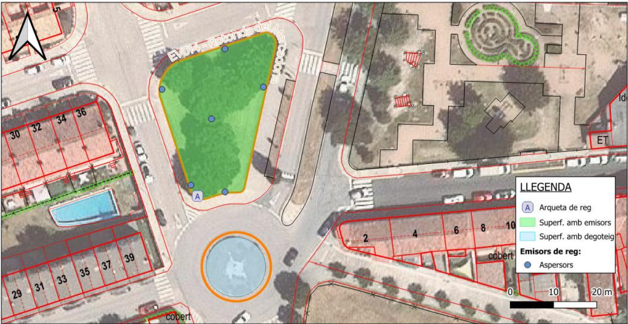
Imatge 44. Inventari del sistema de reg de la Rotonda del Mercadona i de l'espai verd adjacent.
