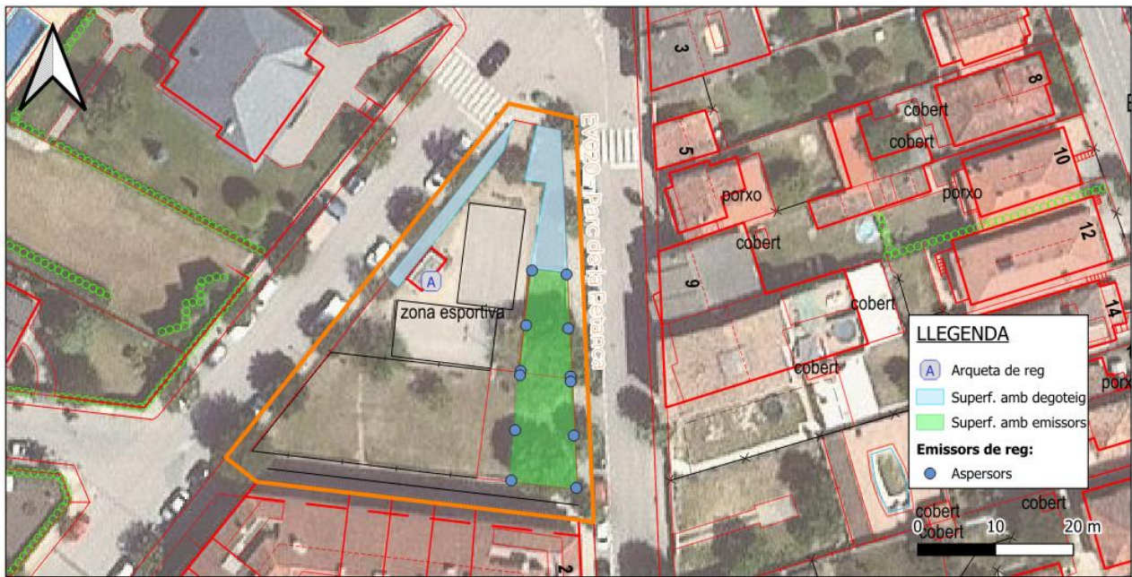
Imatge 56. Inventari del sistema de reg del Parc de la Petanca.
