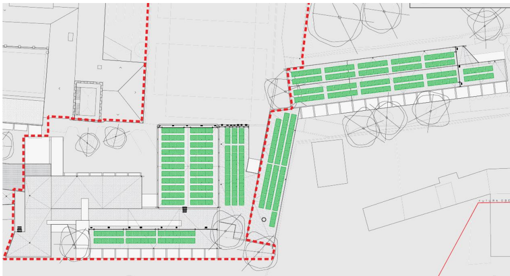
Figura 6. Distribució del camp fotovoltaic.
