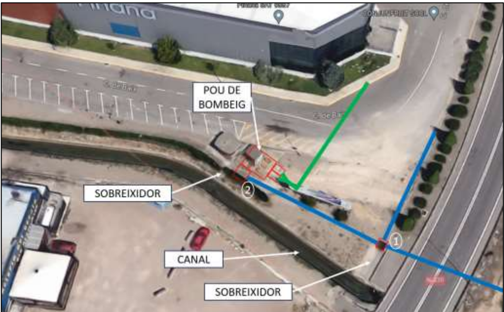
Croquis de la instal·lació de sanejament
