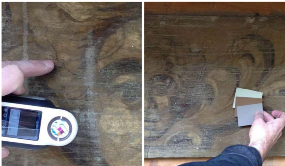
Lectura amb colorímetre portàtil d'una superfície pintada i contratipat amb les cartolines patró.
