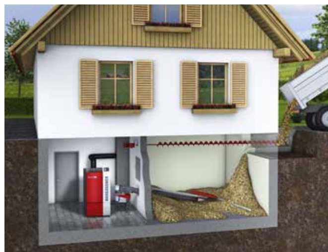
Sala de calderas y silo en el sótano del edificio
