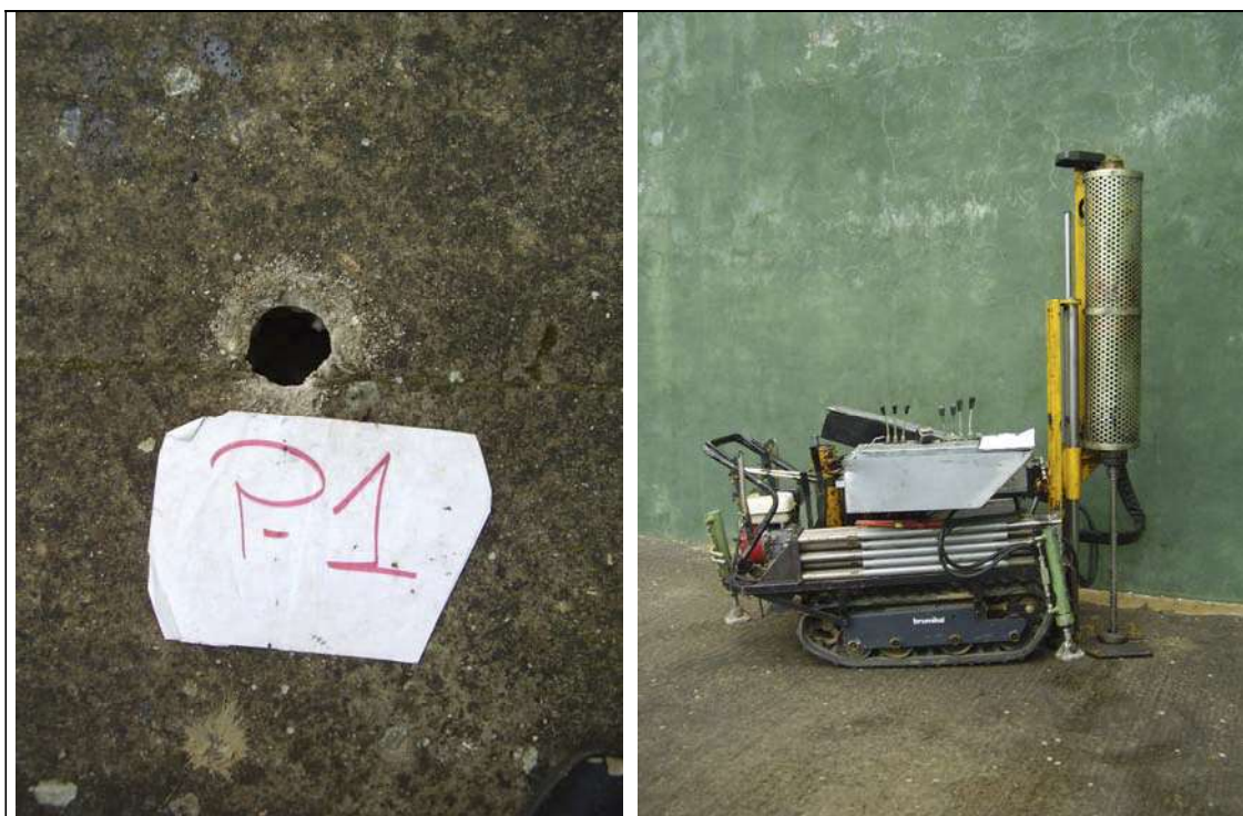
Fotografia 2. Màquina de penetròmetre treballant en el punt P-1 i testimoni del forat de sondeig.
