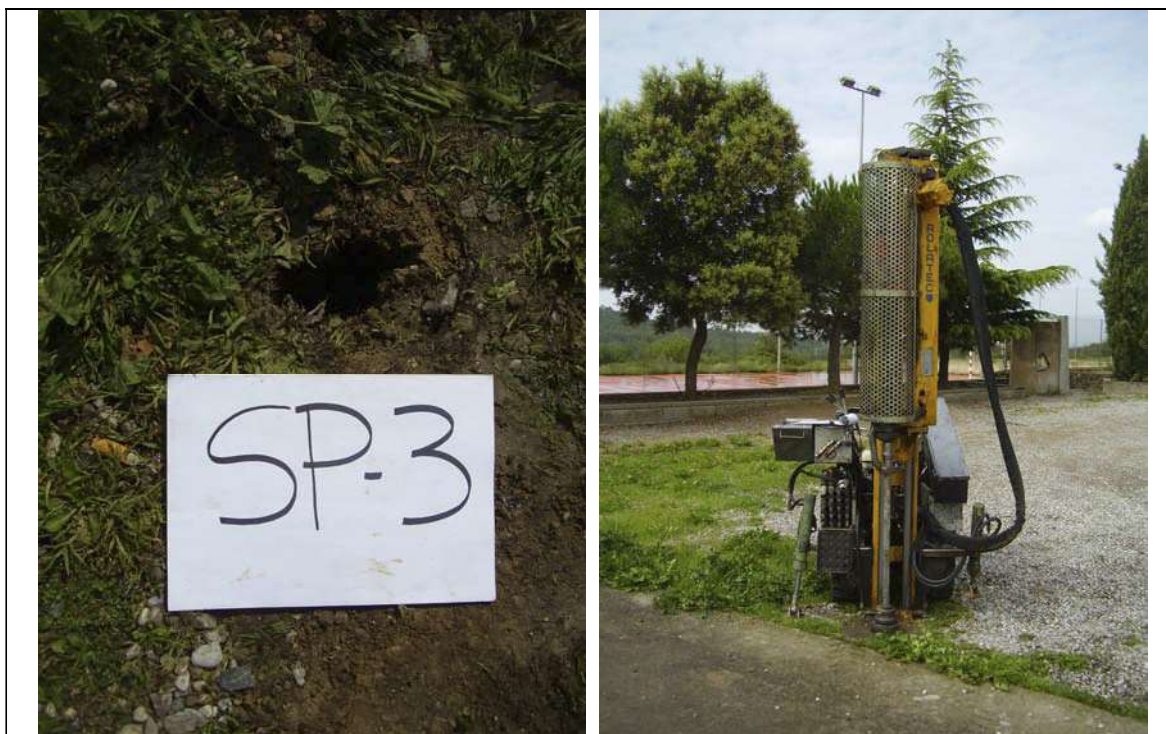
Fotografia 4. Màquina treballant en el sondeig de percussió SP-3 i testimoni del forat de sondeig.
