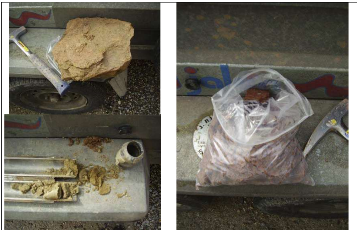
Fotografia 5. Detall de les mostres extreïdes del Sondeig i les seccions estratigràfiques
