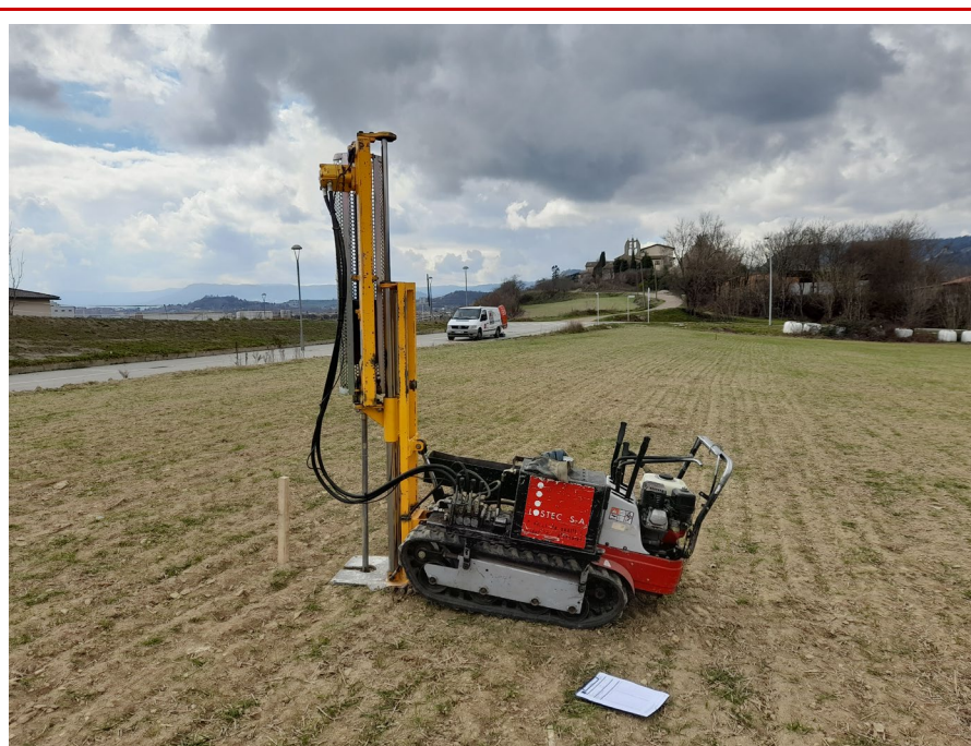
Fotografia 9 – Equip d'assaig penetromètric en el punt d'assaig P-9
