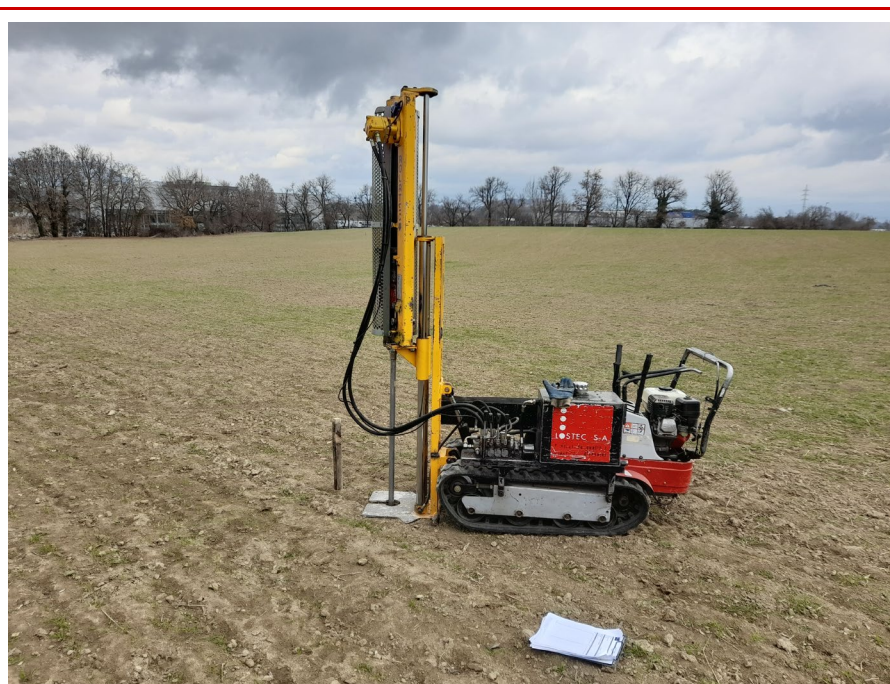
Fotografia 7 – Equip d'assaig penetromètric en el punt d'assaig P-7
