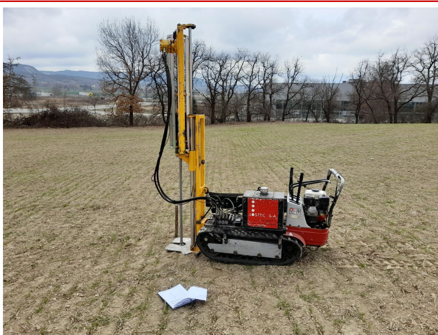
Fotografia 2 – Equip d'assaig penetromètric en el punt d'assaig P-2
