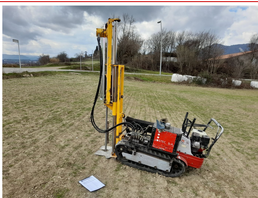
Fotografia 10 – Equip d'assaig penetromètric en el punt d'assaig P-10
