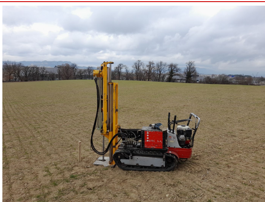
Fotografia 6 – Equip d'assaig penetromètric en el punt d'assaig P-6
