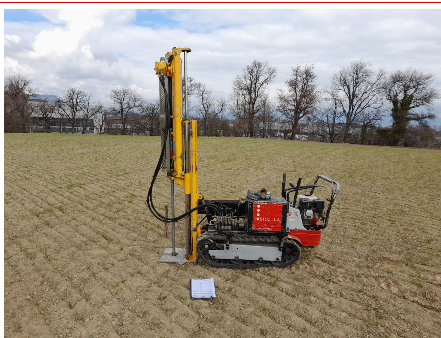
Fotografia 8 – Equip d'assaig penetromètric en el punt d'assaig P-8
