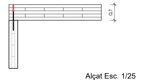
Detall 5. Recolzamernt de Forjat sobre Mur. Esc 1/25
