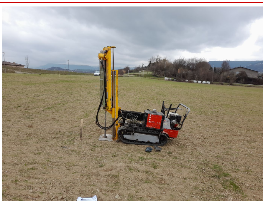
Fotografia 5 – Equip d'assaig penetromètric en el punt d'assaig P-5
