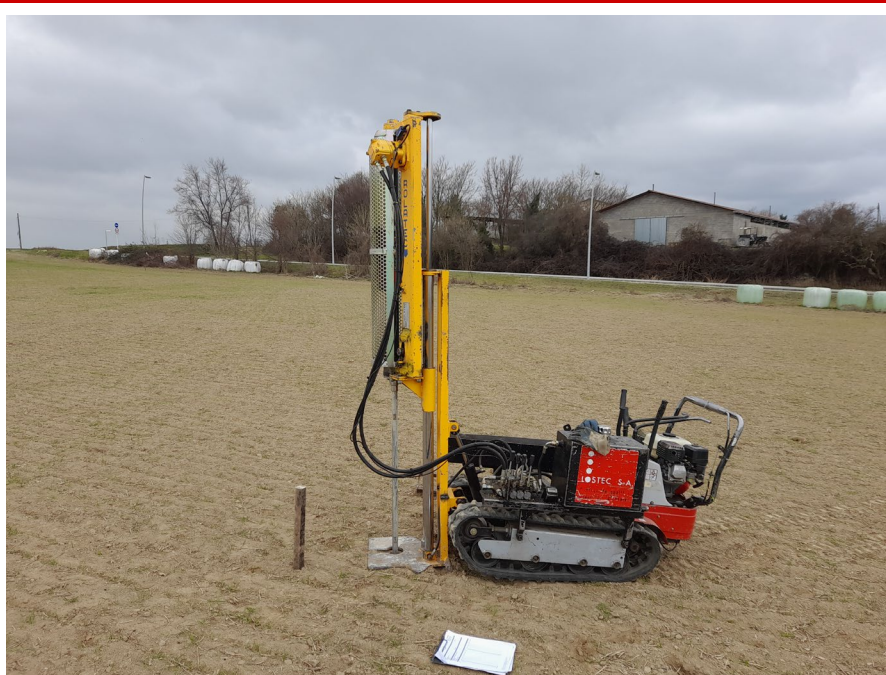
Fotografia 4 – Equip d'assaig penetromètric en el punt d'assaig P-4
