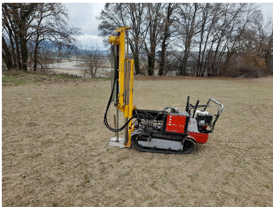
Fotografia 3 – Equip d'assaig penetromètric en el punt d'assaig P-3
