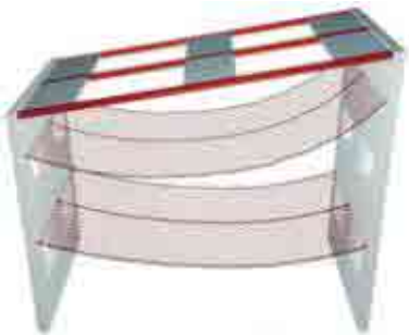
XARXA HORIZONTAL PER CAIGUDES A DIFERENT NIVELL EN L'ESTRUCTURA
