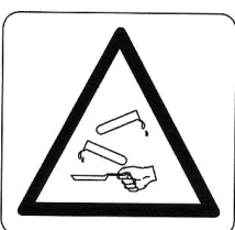
RISC DE CORROSIÓ
