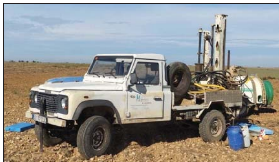
Fotografia 3. Detall de la màquina que realitza els sondeigs a rotació.
