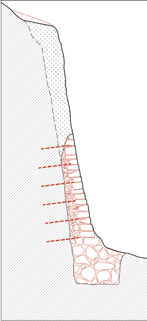
Reintegración del muro de mamposteria con piedra recuperada del lugar en la cara exterior y cascotes en la cara interior, rejuntado con mortero de cal hidráulica natural NHL 3,5. Consolidación del coronamiento.
