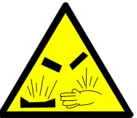
RISC DE CORROSIÓ
