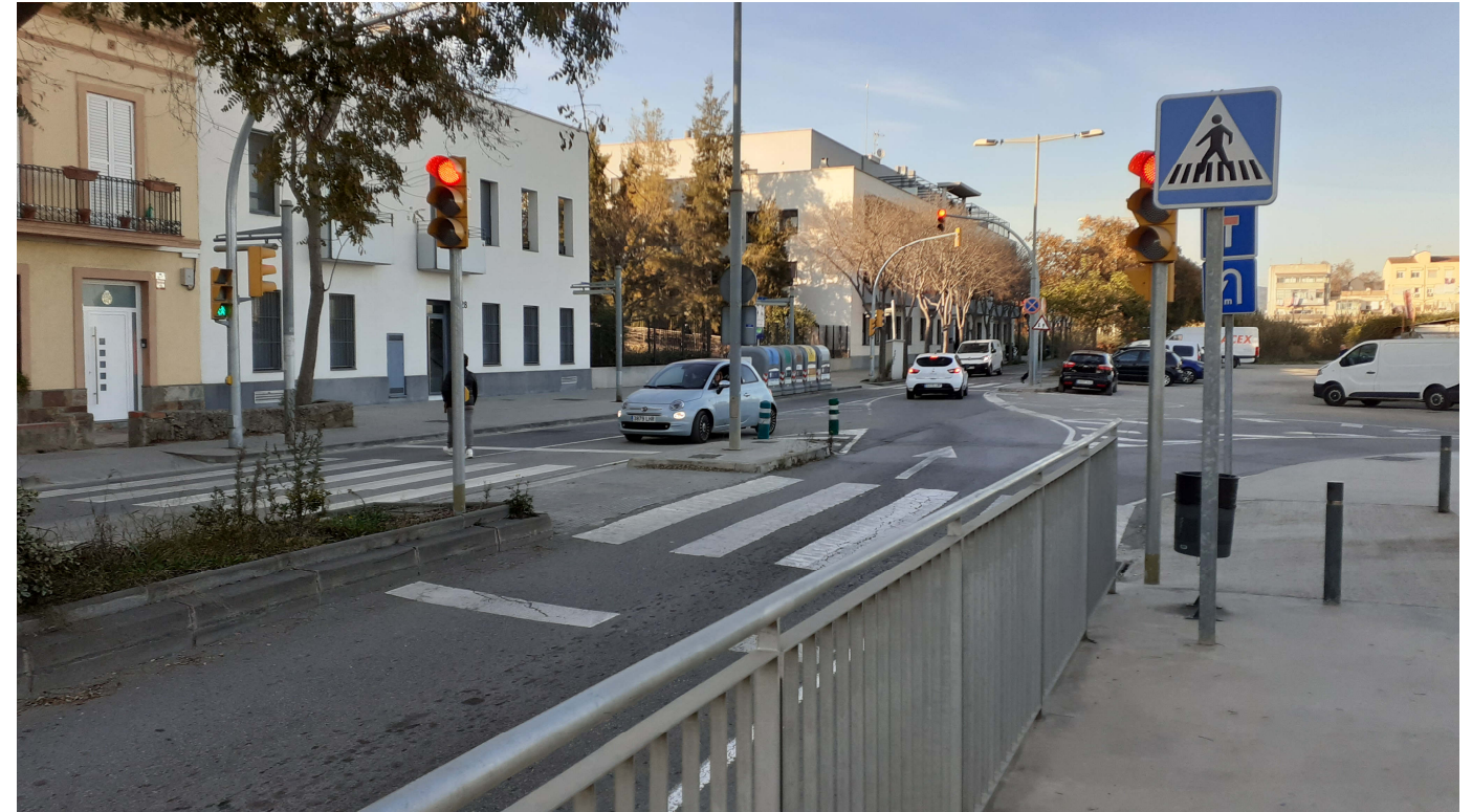
Pas de vianants semaforitzat al extrem nord del sector, davant de l'escola La Susa, amb la vorera de formigó i la reducció de la calçada del carrer Bonaventura Calopa de 4 carrils a dos en direcció nord.
