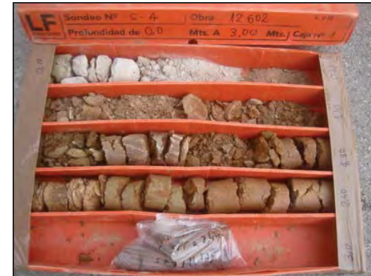
Foto 25: Sondeig S-4, caixa de 0 a 3 metres.
