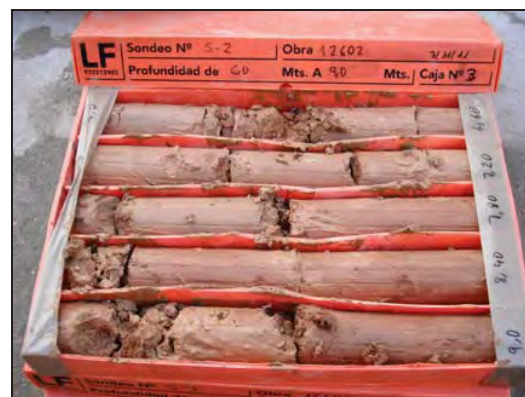
Foto 12: Sondeig S-2 caixa de 6 a 9 metres.
