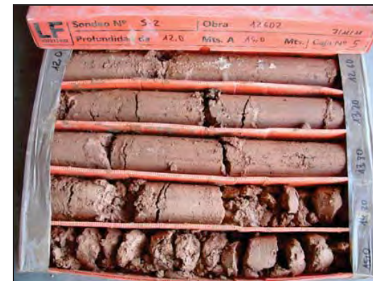
Foto 15: Sondeig S-2 caixa de 12 a 15 metres.
