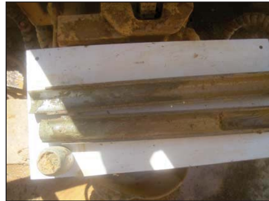
Foto 20: Sondeig S-3, SPT a 5,4 metres.
