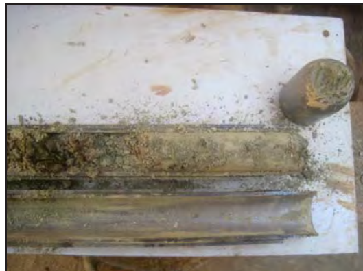
Foto 23: Sondeig S-3, SPT a 9,6 metres.
