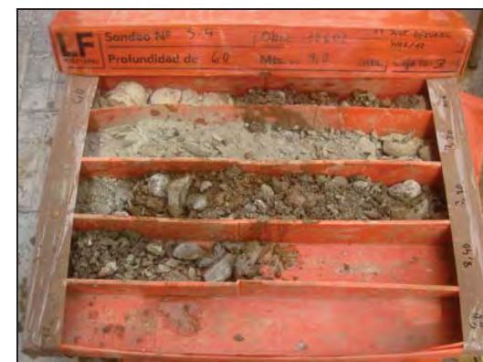
Foto 29: Sondeig S-4, caixa de 6 a 8 metres.
