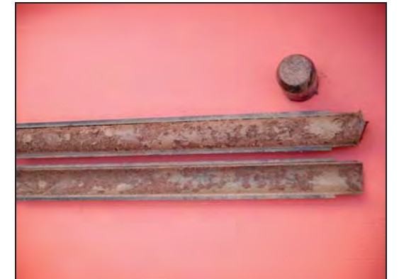
Foto 14: Sondeig S-2, SPT a 9,7 metres.
