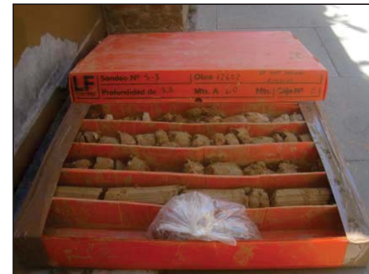
Foto 27: Sondeig S-4, caixa de 3 a 6 metres.
