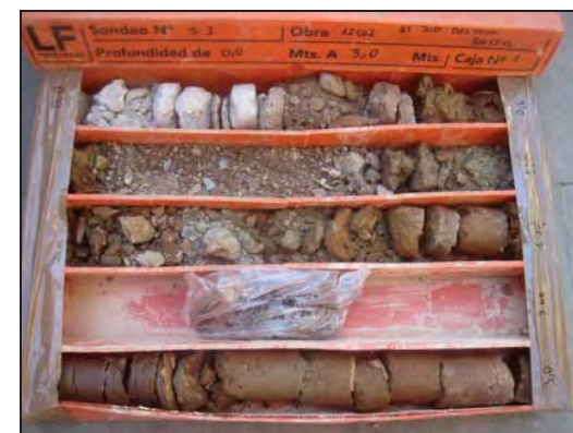
Foto 17: Sondeig S-3 caixa de 0 a 3 metres.
