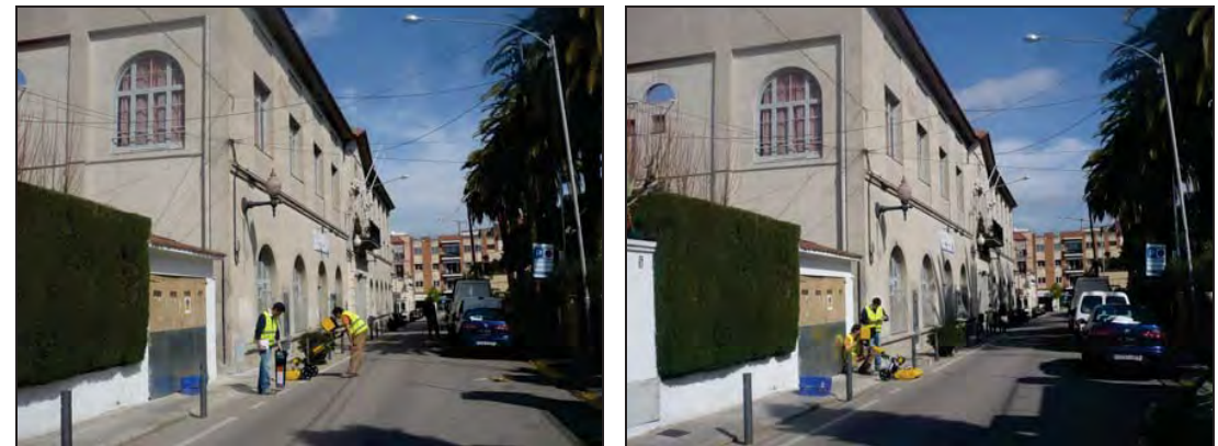
Passant detector de cables y georadar al carrer Ateneu.
