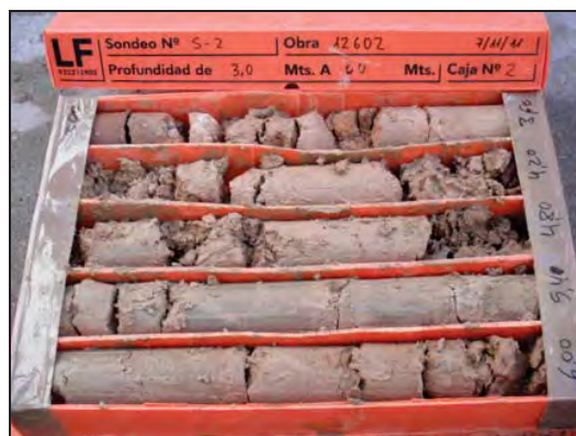
Foto 11: Sondeig S-2 caixa de 3 a 6 metres.
