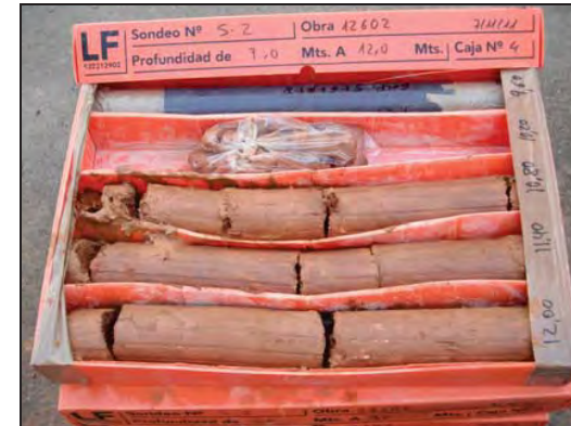
Foto 13: Sondeig S-2 caixa de 9 a 12 metres.
