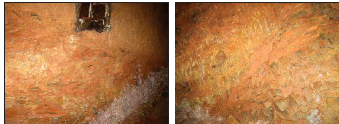
Detall d'argiles amb graves de pissarra. Pissarres amb més matriu d'argiles.
