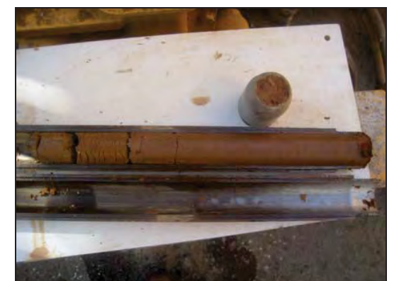
Foto 18: Sondeig S-3, SPT a 1,8 metres.
