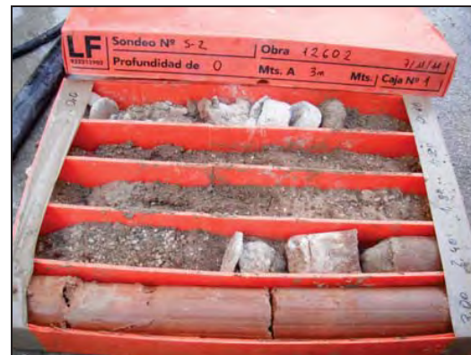
Foto 10: Sondeig S-2 caixa de 0 a 3 metres.
