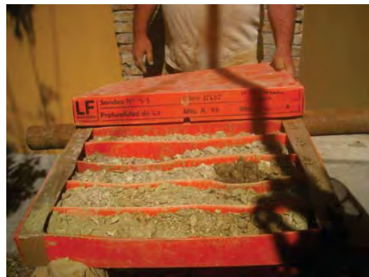
Foto 21: Sondeig S-3, caixa de 6 a 9 metres.
