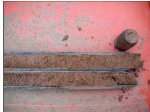
Foto 8: Sondeig S-1, SPT a 9,7 metres.
