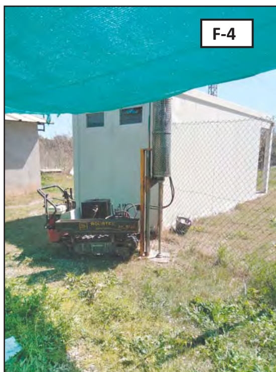
Fotografies 3 i 4: Vista de l'emplaçament de la màquina per a la realització dels assaigs de penetració dinàmica DPSH, P-2 i P-3, respectivament.
