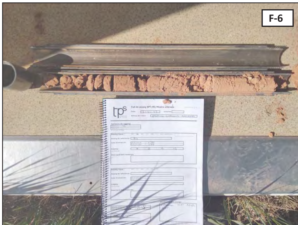
Fotografies 5 i 6: Vista de l'emplaçament de la màquina per a la realització de l'assaig de penetració dinàmica DPSH P-4, i detall dels materials recuperats en l'assaig SPT-1.
