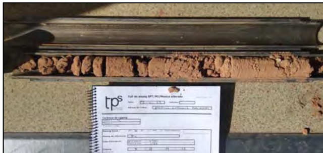
Fotografia 4. Detall dels materials recuperats en l'assaig SPT-1.
