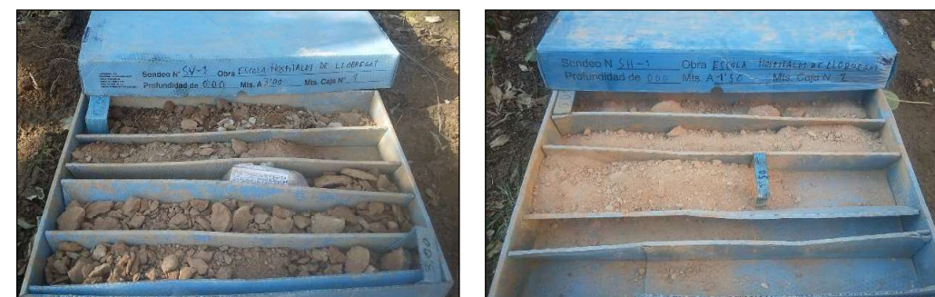
Fotografia 8 i 9. Detall dels materials del primer nivell tal i com es recuperen en el sondeigs realitzats, a l'esquerra el vertical i a la dreta l'horitzontal.
