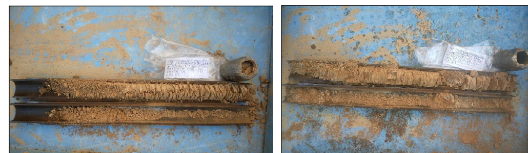
Fotografia 10 i 11. Detall dels materials recuperats en els dos assaigs SPT's realitzats.
