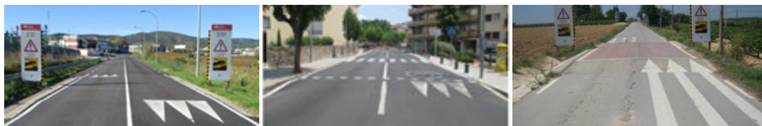
Plataforma reductora de velocitat en secció
