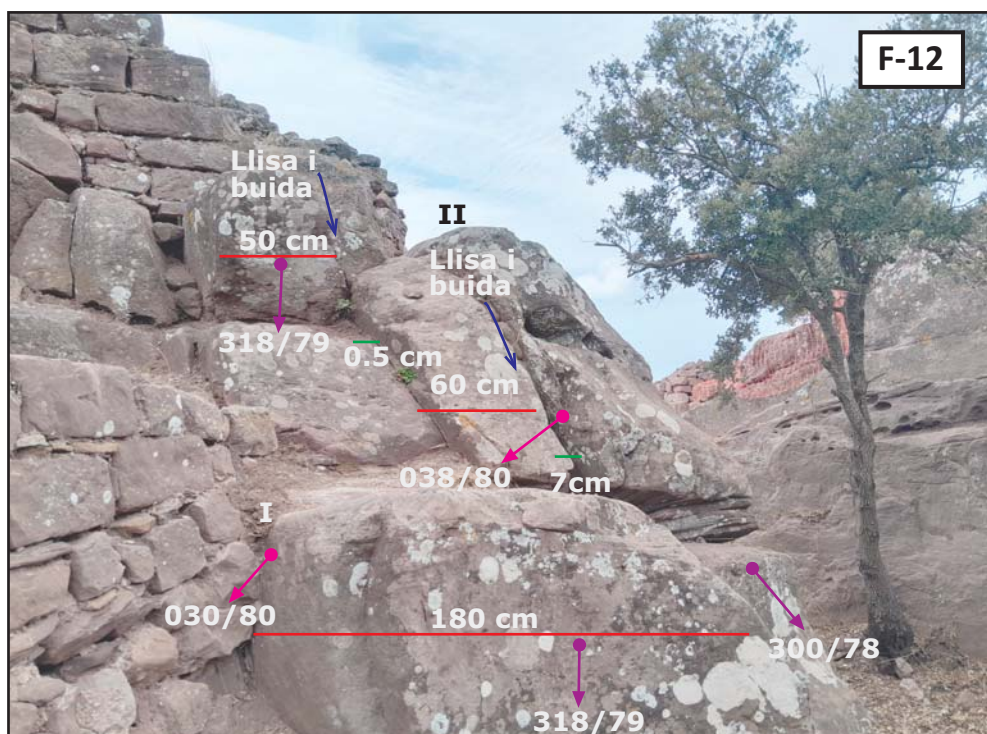
Fotografies 11 i 12: Estació geomecànica 2 i dades: en vermell, les distàncies entre diàclasis; en blau, la descripció de les diàclasis; en verd, les obertures de les diàclasis; en rosa i lila, les mesures de les famílies de diàclasis (D1 i D2, respectivament).
