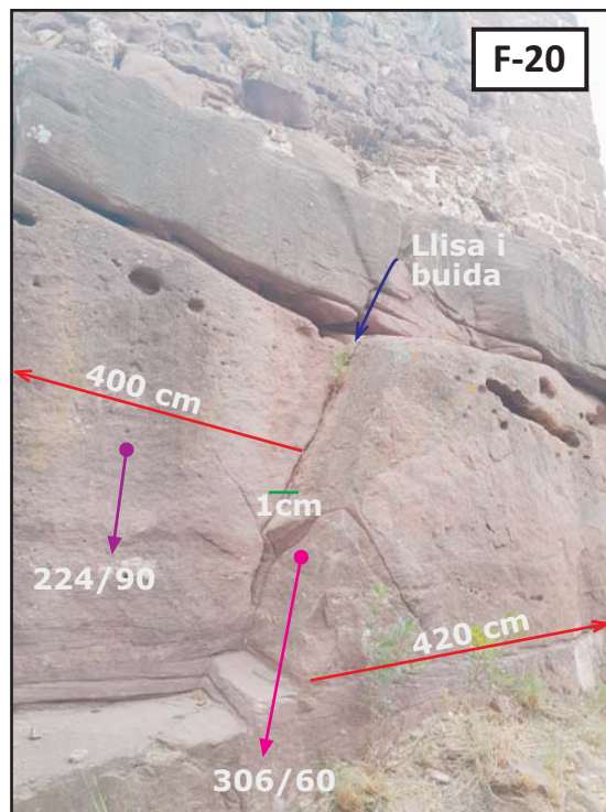
Fotografies 19 i 20: Estació geomecànica 3 i dades: en vermell, les distàncies entre diàclasis; en blau, la descripció de les diàclasis; en verd, les obertures de les diàclasis; en rosa i lila, les mesures de les famílies de diàclasis (D1 i D2, respectivament).
