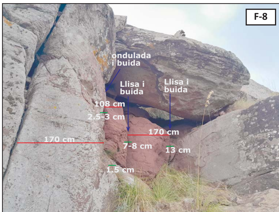
Fotografies 7 i 8: Estació geomecànica 1 i dades: en vermell, les distàncies entre diàclasis; en blau, la descripció de les diàclasis; en verd, les obertures de les diàclasis; en rosa i lila, les mesures de les famílies de diàclasis (D1 i D2, respectivament).
