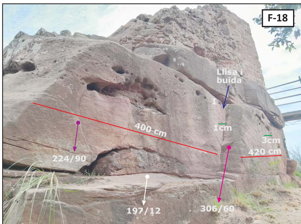
Fotografies 17 i 18: Estació geomecànica 3 i dades: en vermell, les distàncies entre diàclasis; en blau, la descripció de les diàclasis; en verd, les obertures de les diàclasis; en rosa i lila, les mesures de les famílies de diàclasis (D1 i D2, respectivament).
