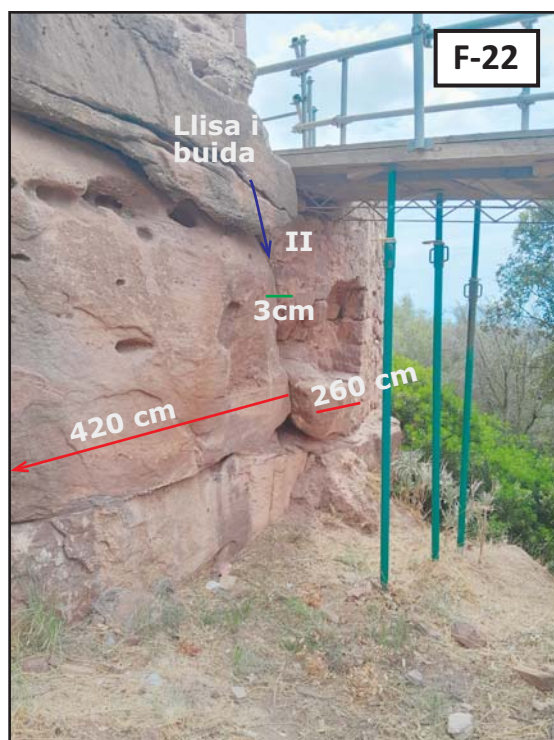
Fotografies 21 i 22: Estació geomecànica 3 i dades: en vermell, les distàncies entre diàclasis; en blau, la descripció de les diàclasis; en verd, les obertures de les diàclasis; en rosa i lila, les mesures de les famílies de diàclasis (D1 i D2, respectivament).
