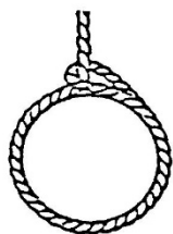
Esto - El ajuste de ojal corta el cable en movimiento.
