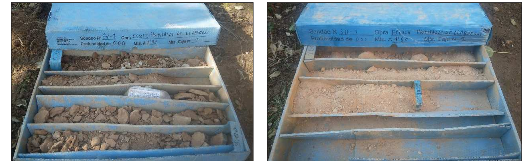
Fotografia 8 i 9. Detall dels materials del primer nivell tal i com es recuperen en el sondeigs realitzats, a l'esquerra el vertical i a la dreta l'horitzontal.
