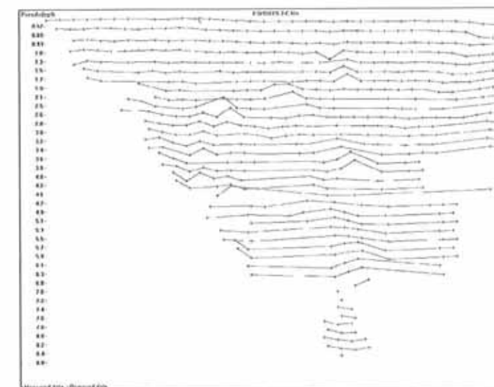
Figura 24. Filtrado de los valores erróneos de resistividad del perfil 2
