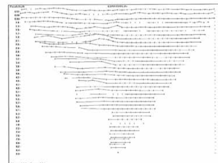
Figura 49. Filtrado de los valores erróneos de resistividad del perfil 6
