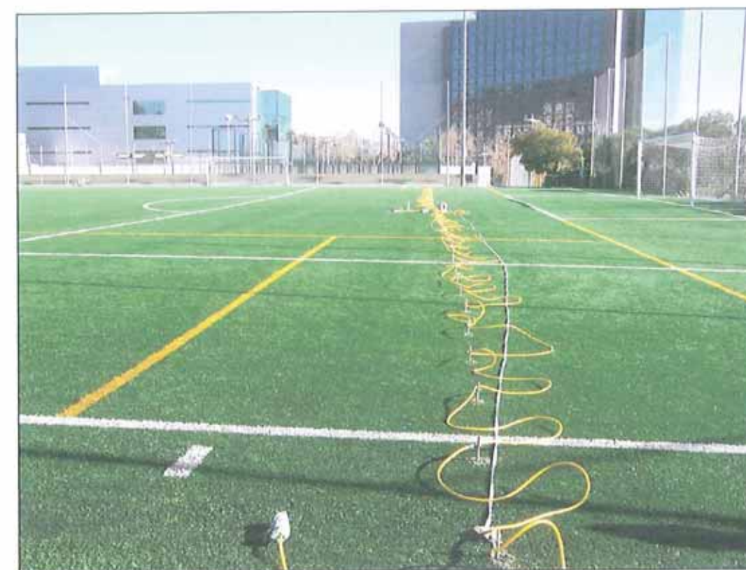
Figura 12. Fotografía del dispositivo de tomografía eléctrica en uno de los perfiles sobre el campo de fútbol de Esports UB
