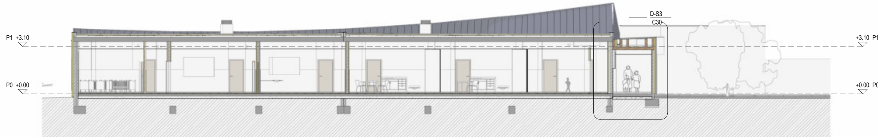
S3- Secció longitudinal edifici existent
