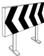
DETALL Platí desviament trànsit
