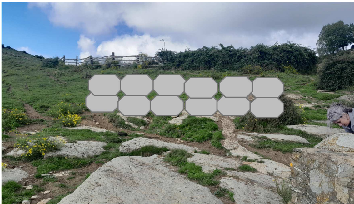
Esquema exemple de la ubicació de l'escullera – costat est a la bassa.
