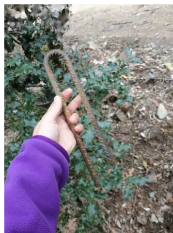
Model de grapa feta de rea, per subjectar el tub conductor d'aigua a terra.
