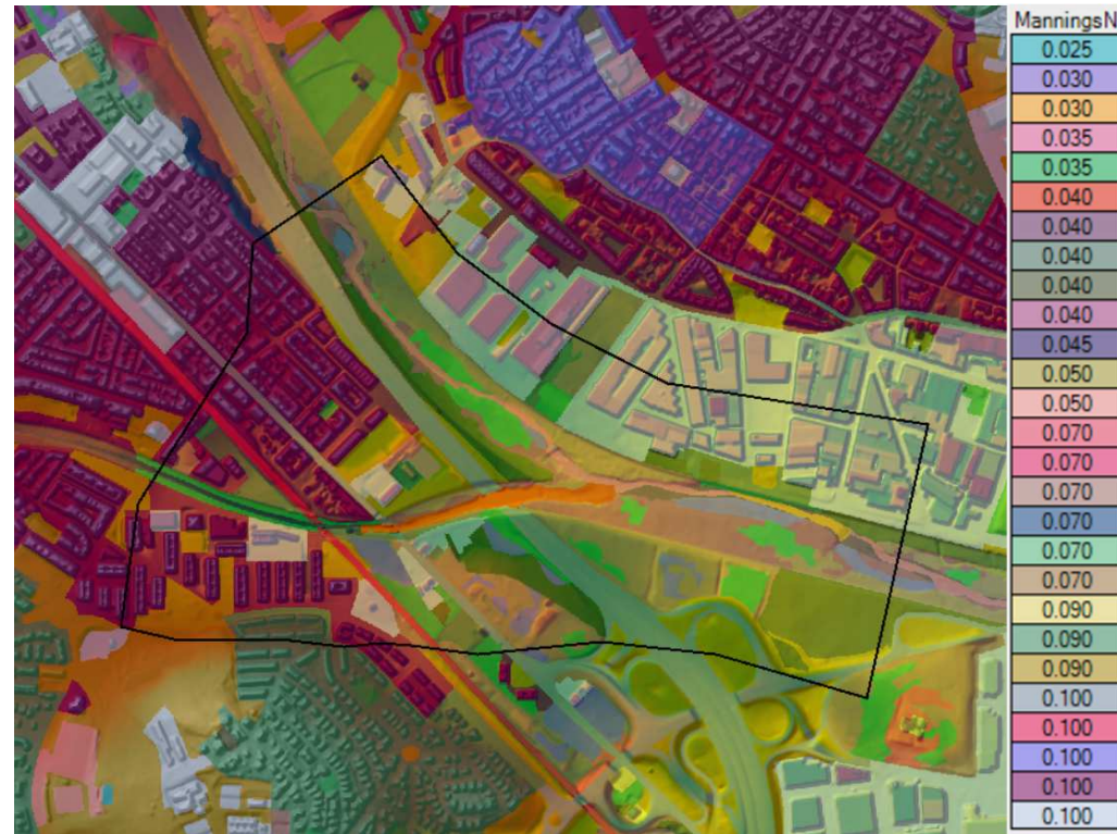
Figura 7. Coeficients de rugositat de Manning adoptats per a l'escenari actual.
