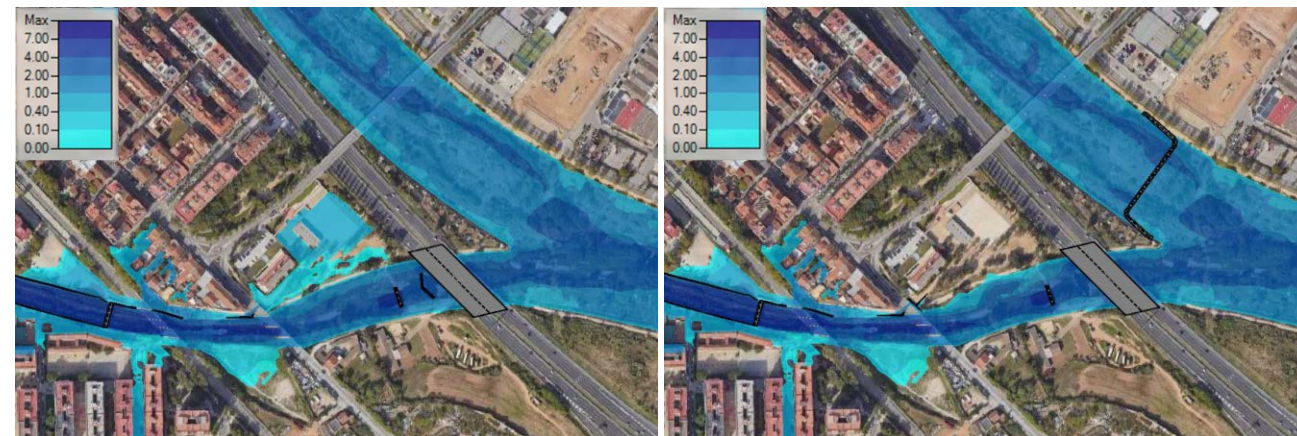
Figura 30. Calats d'inundació associats a les avingudes de 500 anys de període de retorn, en l'escenari actual (esquerra) i en el proposat (dreta).
