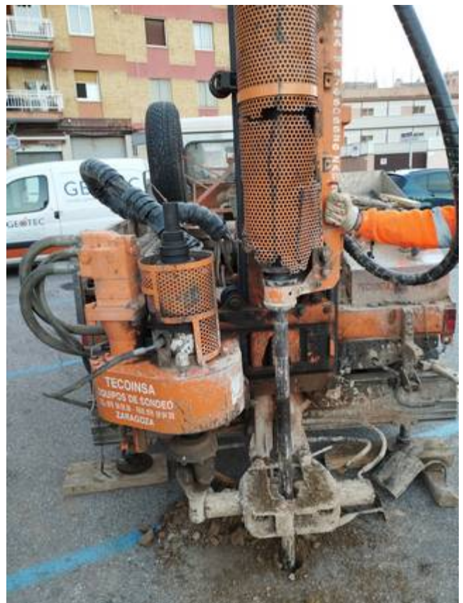
Vistes de quatre dels vuit sondeigs realitzats a la parcel·la objecte d'estudi, P-2 del tipus DPSH i, S-1, S-3 i S-4 del tipus Rotació helicoidal.
