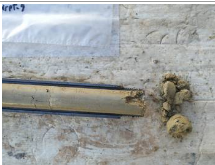
Vistes dels materials del subsòl extrets en un assaig SPT realitzat al llarg del sondeig S-3.
