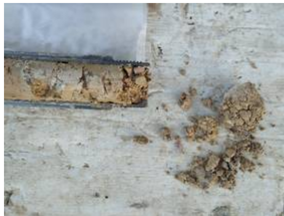
Vistes dels materials del subsòl extrets en quatre assaigs SPT realitzats al llarg del sondeig S-4.
