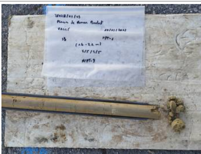
Vistes dels materials del subsòl extrets en un assaig SPT realitzat al llarg del sondeig S-3.
