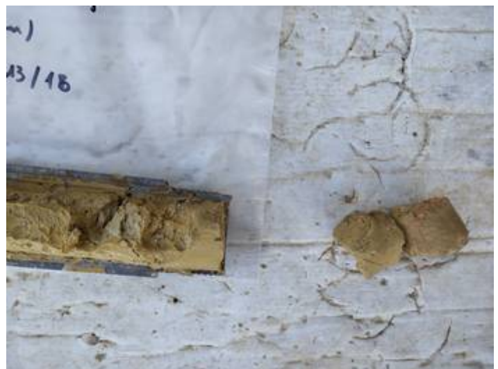
Vistes dels materials del subsòl extrets en tres assaigs SPT realitzats al llarg del sondeig S-7.
