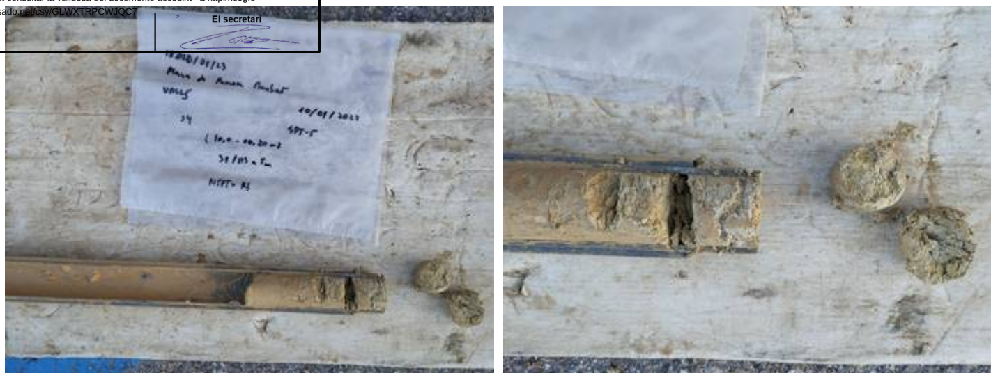
Vistes dels materials del subsòl extrets en un assaig SPT realitzat al llarg del sondeig S-4.
