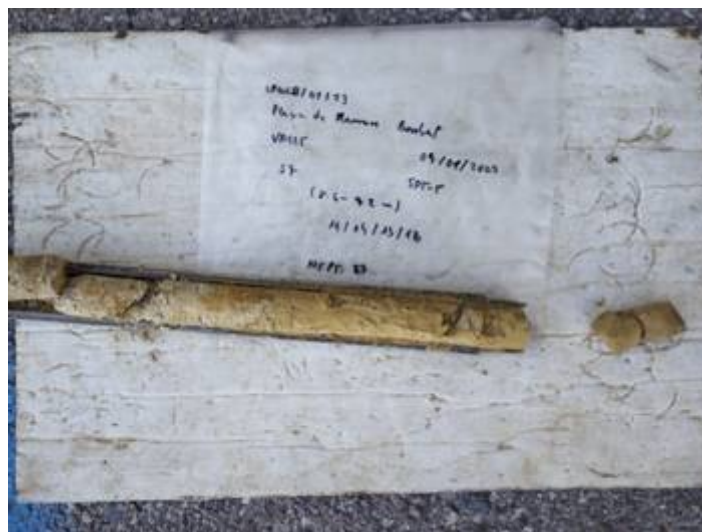
Vistes dels materials del subsòl extrets en tres assaigs SPT realitzats al llarg del sondeig S-7.
