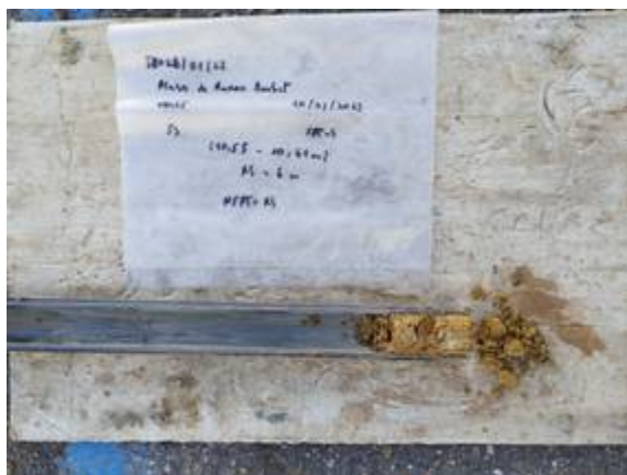
Vistes dels materials del subsòl extrets en quatre assaigs SPT realitzats al llarg del sondeig S-3.
