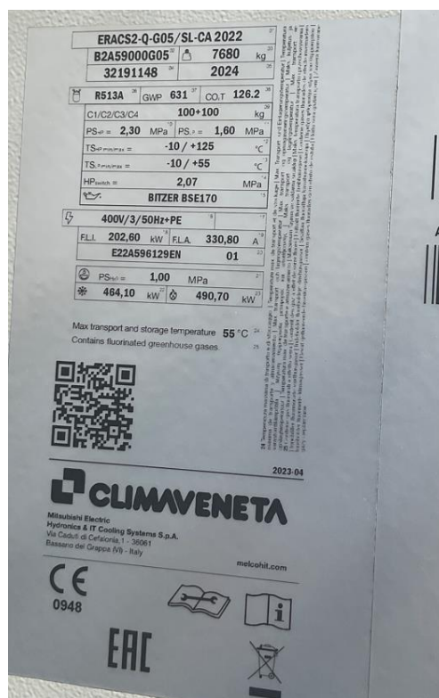
Placa de característiques bomba de calor aire-aigua
