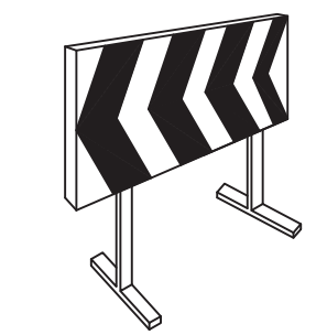
VALLAS DESVIO TRAFICO
