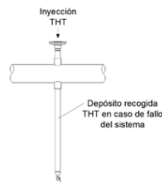
Detalle posición punto de inyección
