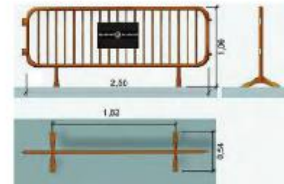
Valla provisional d'obra
