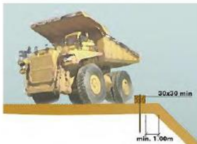
Esquema límit retrocés en abocament de terres
