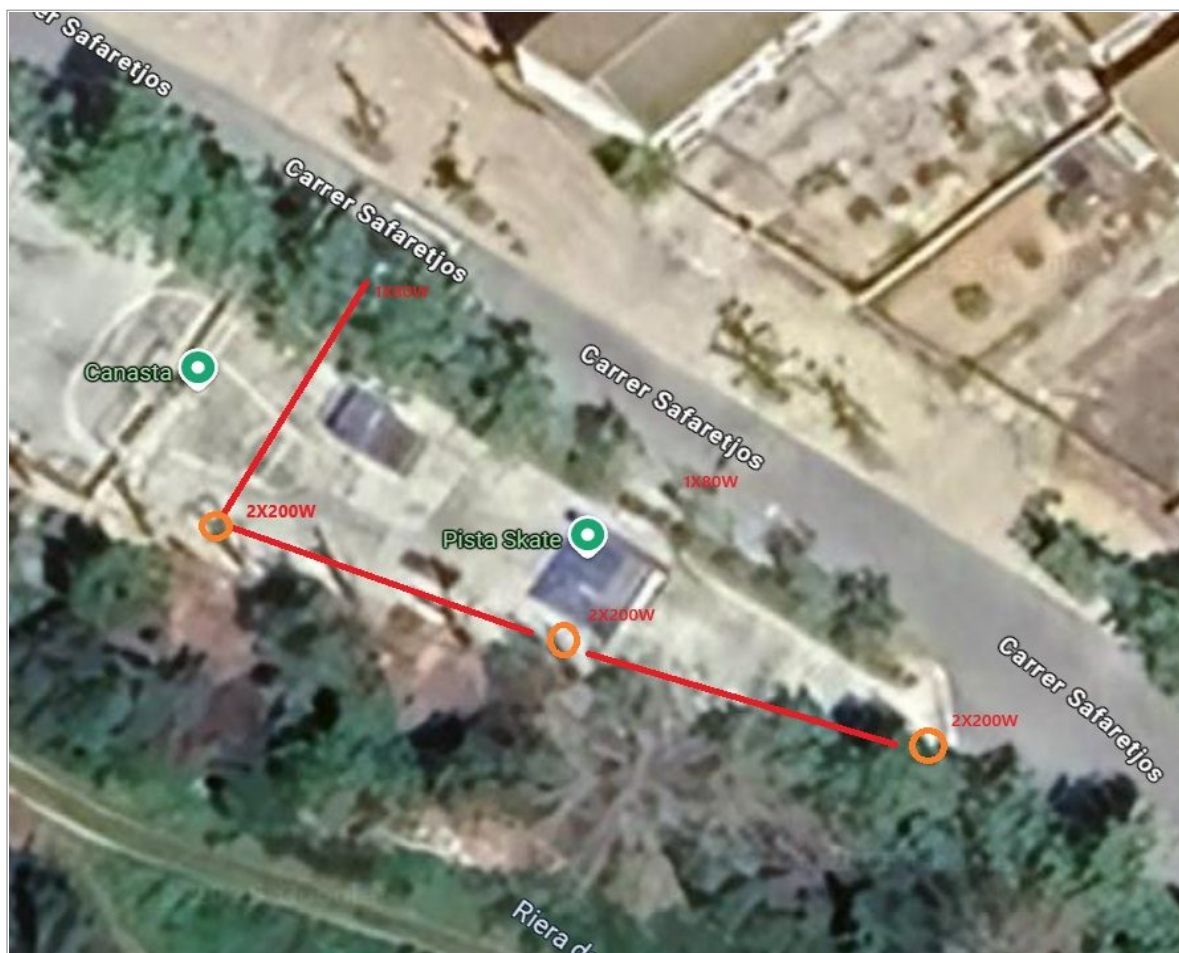
Imatge 4 Nous punts de llum (circumferència taronja), i rases (línia vermella) instal·lació enllumenat
