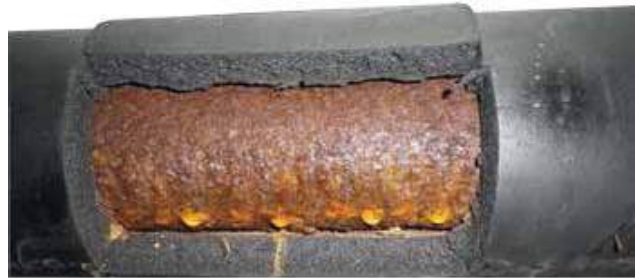
Estado tubería de acero aislada con corrosión por condensación.
