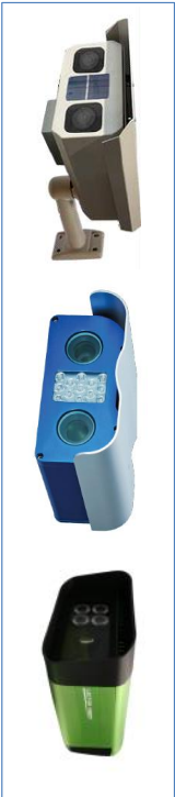
Il·lustració 21: Exemples d'equips de reconeixement de matrícules d'una carcassa amb 2 sensors (BN/IR+Color)
