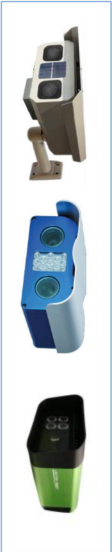
Il·lustració 4: Exemples d'equip de reconeixement de matrícules amb una carrossa
