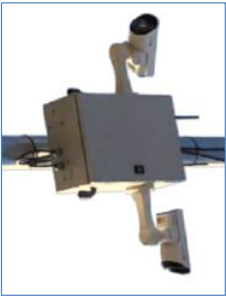
Il·lustració 4: Exemples d'equip de reconeixement de matrícules amb una carrossa
