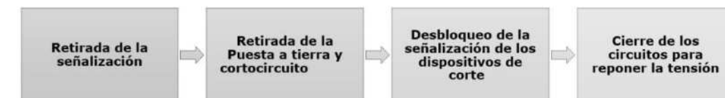
Figura 9. Pasos para trabajar sin tensión y restauración (Instrucción Tersa IESFV)
