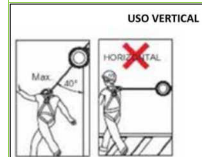
Figura 7. Ejemplo posicionamiento incorrecto dispositivo retráctil
