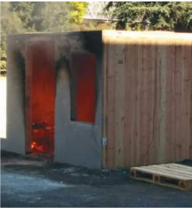
Test de incendio a escala real de una estructura CLT
