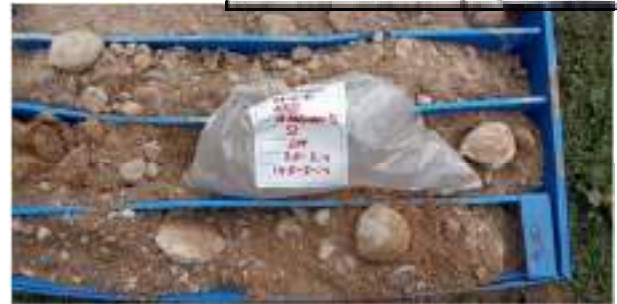
Aspecte dels materials de la unitat Q2 extrets als sondejors
