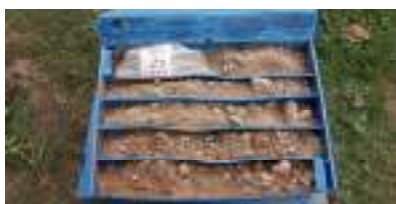
Sondeig S1 caixa 4 (9,00 a 12,00 m)
