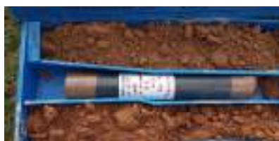
Caixa 2. Detall argiles llimoses
