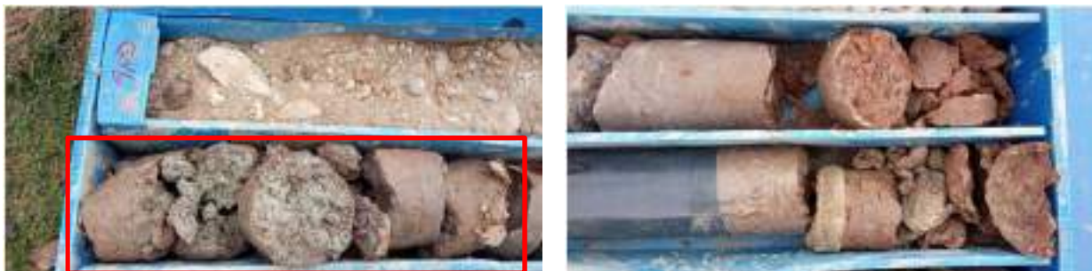
Materials de la unitat S extrets dels sondejos
