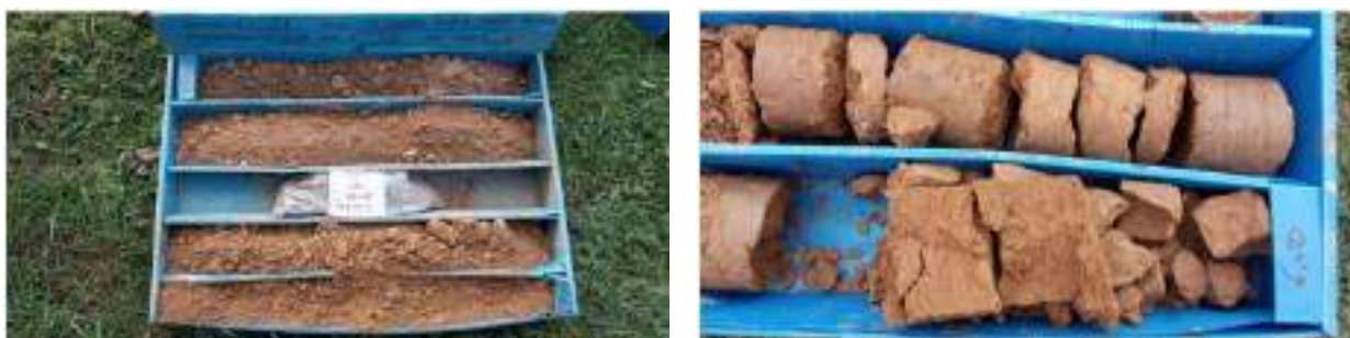
Aspecte dels materials de la unitat Q1 extrets als sondejors
