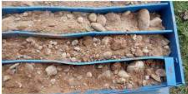
Aspecte dels materials de la unitat Q2 extrets als sondejors
