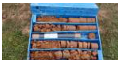
Sondeig S2 caixa 2. (3,00 a 6,00 m)
