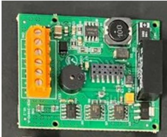
Imatge 5: Vista placa alimentació RFID interruptor CAN
