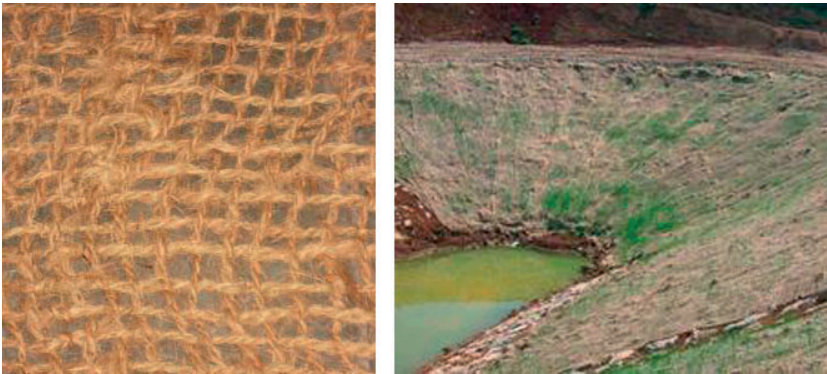
Biomalla tipus manta orgànica tipus 50% palla i 50% coco
