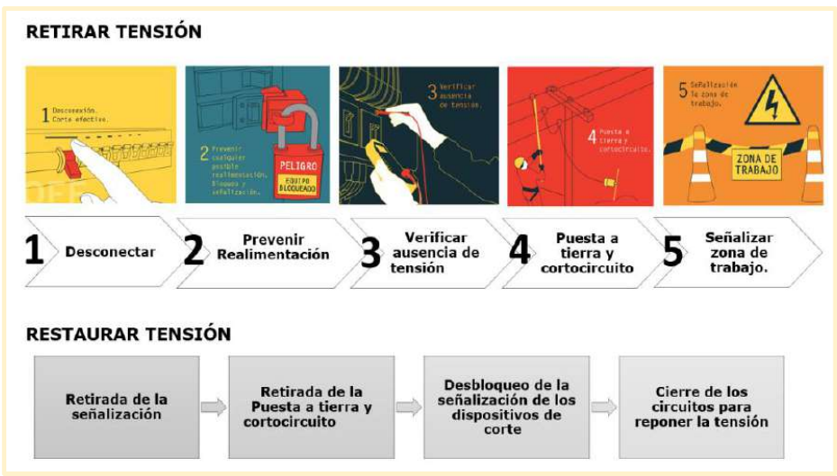
Figura 9. Pasos para trabajar sin tensión y restauración (Instrucción Terna IESFV)
