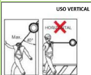
Figura 7. Ejemplo posicionamiento incorrecto dispositivo retráctil
